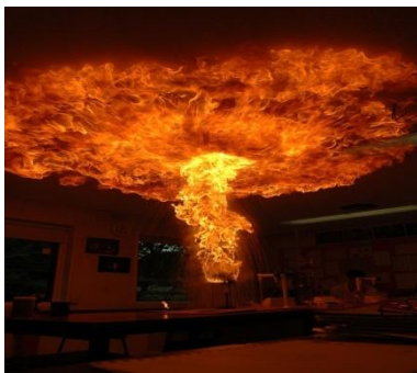
Εικόνα 7 Φαινόμενο rollover. (πηγή: www.pinterest.com )
