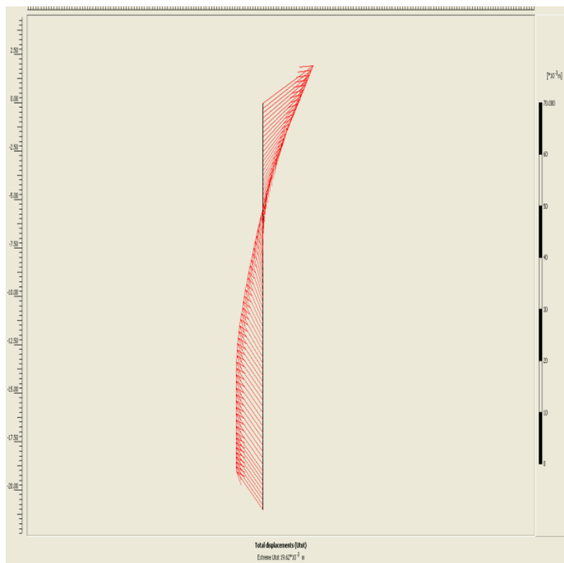
Εικόνα 6.18 : Συνολικές μέγιστες μετακινήσεις διαφραγματικού τοίχου για το προσομοίωμα B1A. Αποτελέσματα 3 Α Ανάλυσης
