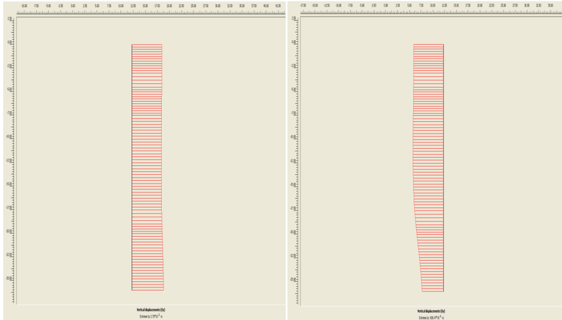
Μέγιστες Κατακόρυφες μετακινήσεις των πασσάλων της κύριας εκσκαφής (από αριστερά προς τα δεξιά) για αντιστήριξη με αντηρίδες και αγκύρια και μόνο αγκύρια
