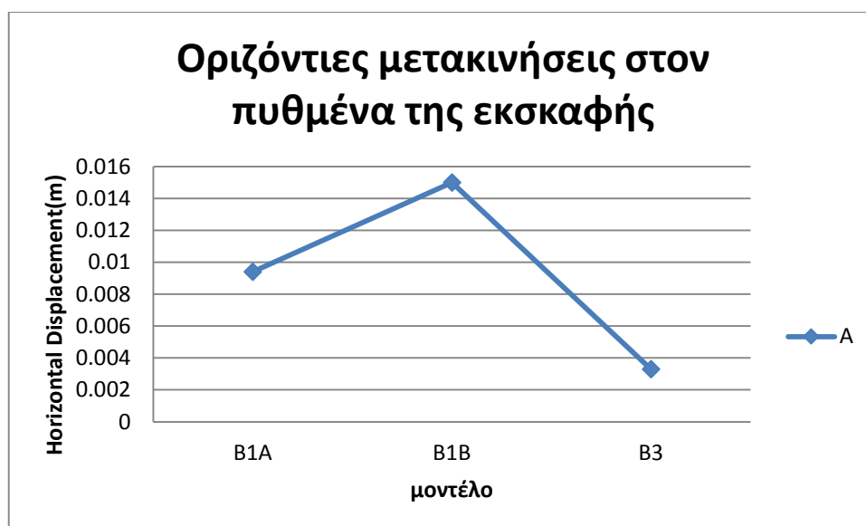
Διάγραμμα 6.15: Αποτελέσματα 3 ης σειράς παραμετρικών αναλύσεων για το πυθμένα της εκσκαφής επί του διαφραγματικού τοίχου (σημείο A).
