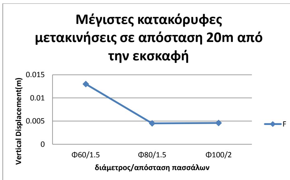
Διάγραμμα 6.9: Αποτελέσματα 2 ης σειράς παραμετρικών αναλύσεων συνάρτηση της διαμέτρου και της απόστασης των πασσάλων για το πιο απομακρυσμένο σημείο.
