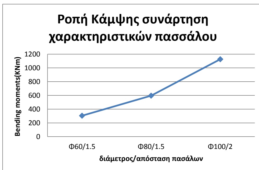
Διάγραμμα 6.10: Αποτελέσματα 2 ης σειράς παραμετρικών αναλύσεων συνάρτηση της διαμέτρου και της απόστασης των πασσάλων.
