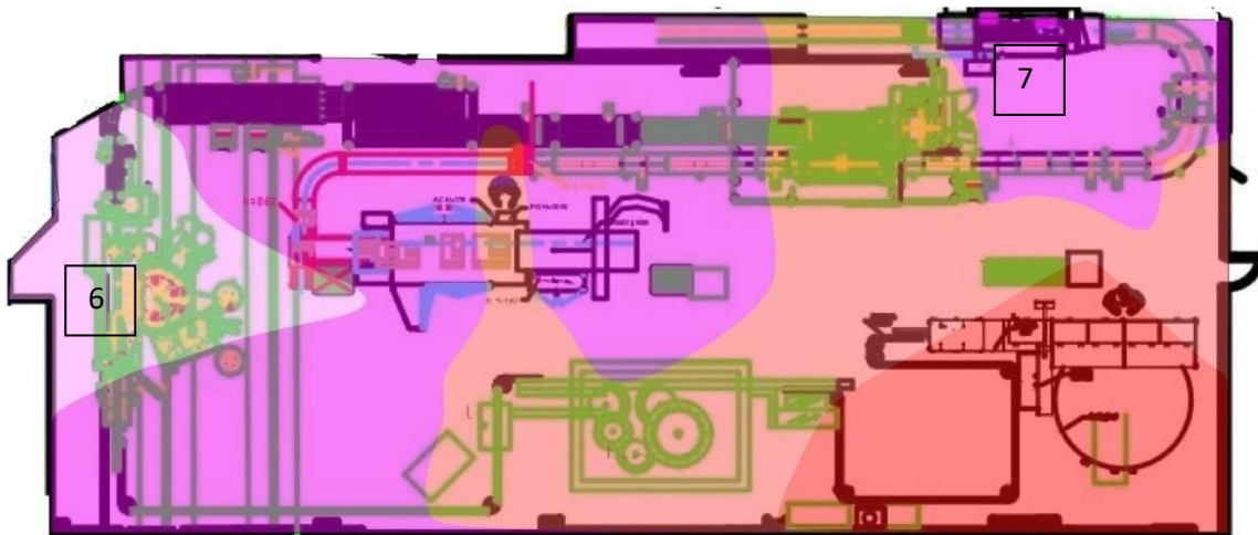
Σχήμα 3.3.2: Χάρτης θορύβου του κτηρίου 2, σημεία μελέτης.
