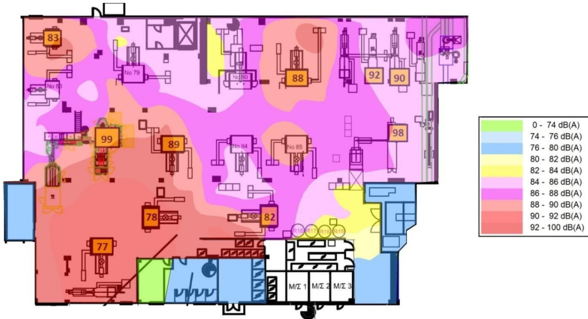
Σχήμα 3.5.2: Χάρτης θορύβου του Κτηρίου 3 για την μέτρηση 2.
