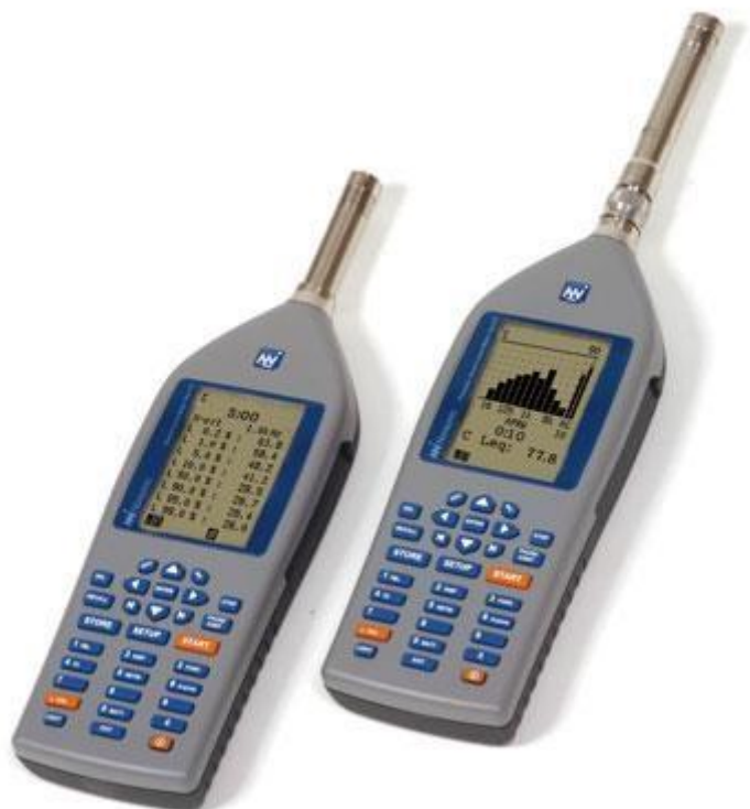
Σχήμα 2.2: Ηχόμετρο Nor131 της εταιρείας Norsonic [4].
