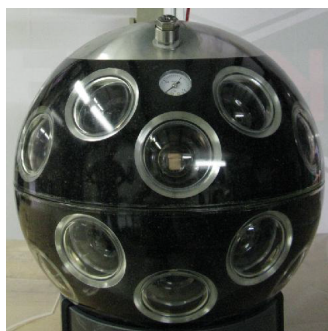
Σχήμα 2.12: Οπτικά στοιχεία του ανιχνευτή KM3NeT
