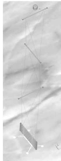
Σχήμα 2.7: Σχηματική αναπαράσταση του ανιχνευτή NESTOR (αριστερά) και του ανιχνευτή NEMO (δεξιά)
