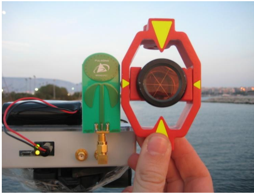
Σχήμα 5.8 Μέτρηση απόστασης με χρήση κατάφωτου Figure 5.8 Range Measurement with mini prism
