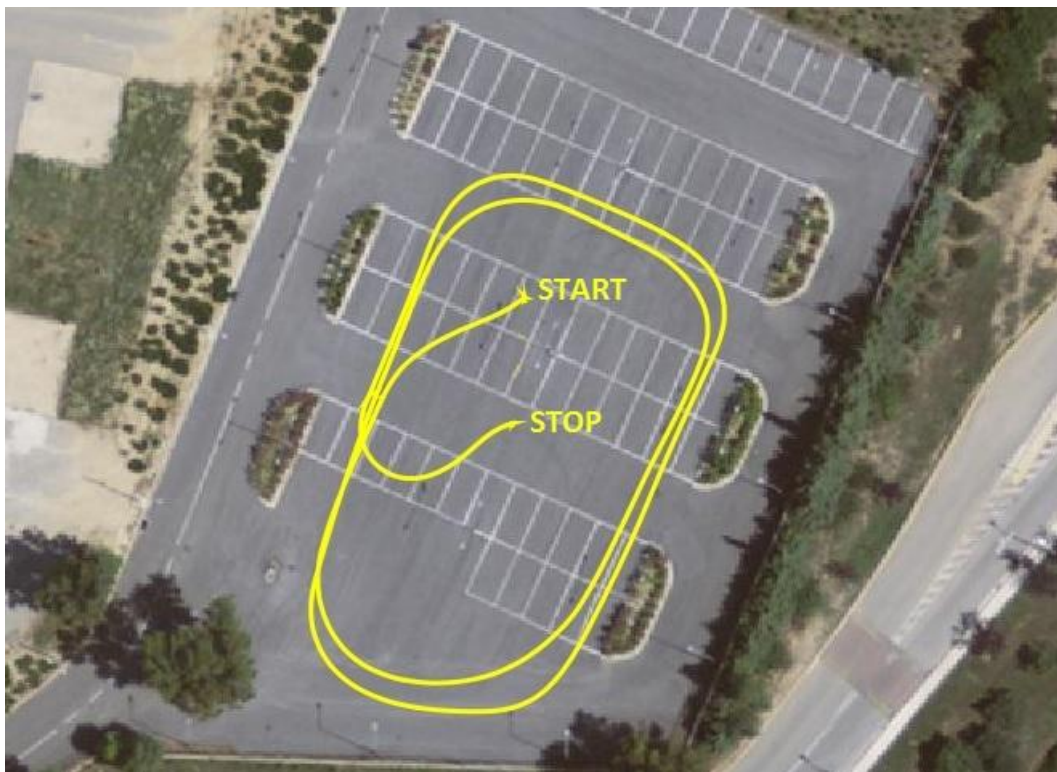
Σχήμα 6.8: Τροχιά οχήματος για το σενάριο S-I από μετρήσεις GNSS/IMU Figure 6.8 Vehicle Trajectory for scenario S-I using the GNSS/IMU system
