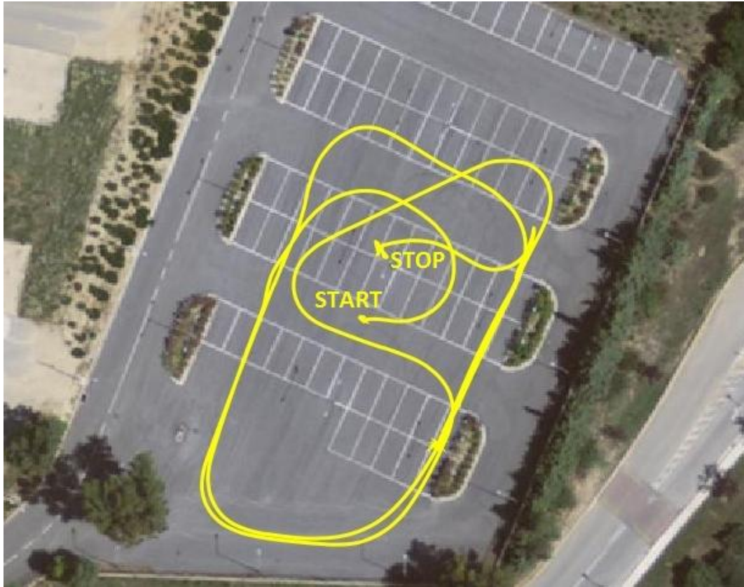
Σχήμα 6.9: Τροχιά οχήματος σεναρίου S-II από μετρήσεις GNSS/IMU Figure 6.9 Vehicle trajectory of scenario S-II using the GNSS/IMU system
