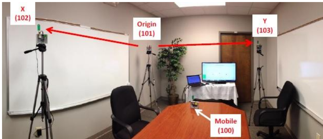
Σχήμα 4.7 Ενδεικτική διάταξη των πομποδεκτών UWB PulsON® 410 για εντοπισμό με τη χρήση του λογισμικού RangeNet® [www.timedomain.com]
