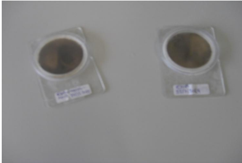
Εικόνα 9.6: Επιβαρυμένα φίλτρα από τις δειγματοληπτικές καύσεις σε σόμπες pellet των 10 και 8,5 kW αντίστοιχα.
