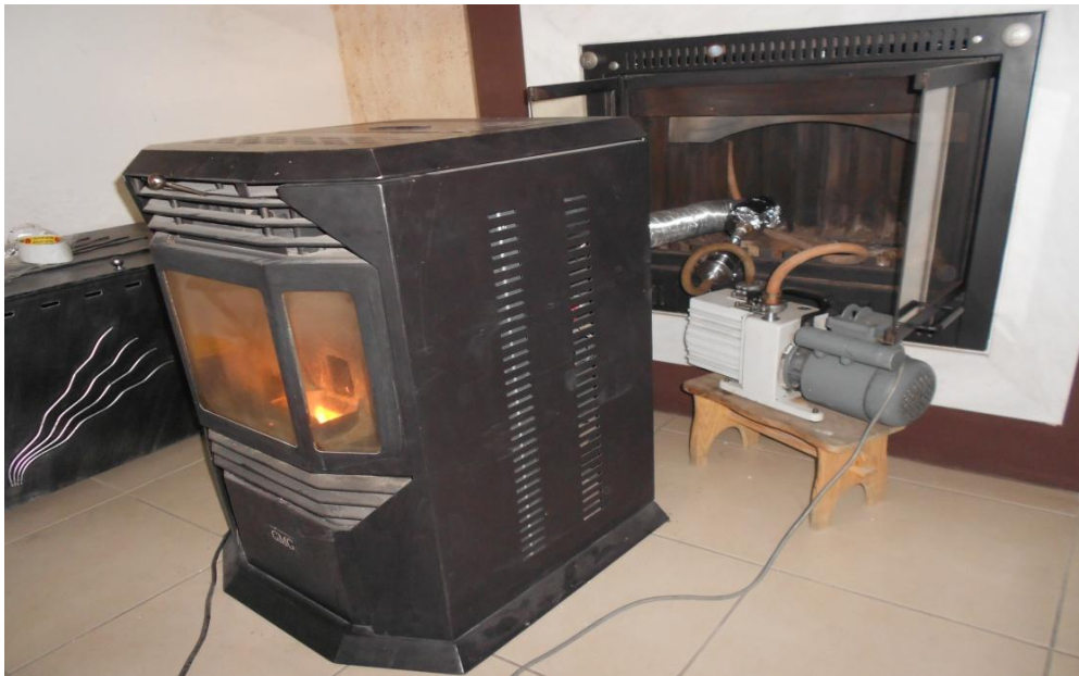
Εικόνα 7.16: Διάταξη καύσης pellet και δειγματοληψίας των εκπεμπόμενων αιωρούμενων σωματιδίων PM 10 σε σόμπα pellet 10 kW.
