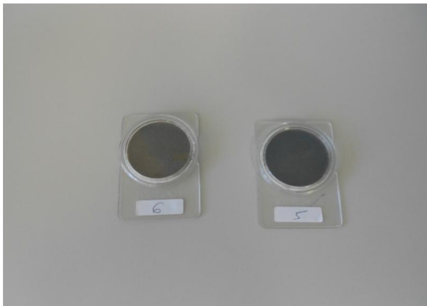
Εικόνα 9.5: Επιβαρυσμένα φίλτρα από τις εργαστηριακές συνθήκες με 13% O 2 στα απαέρια.
