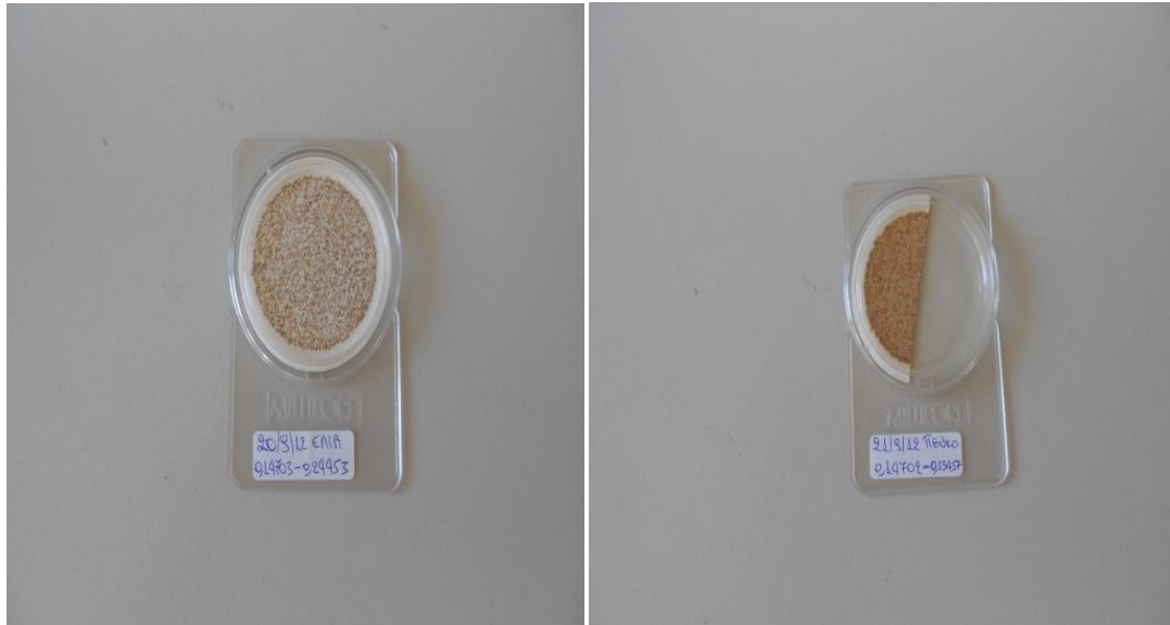
Εικόνα 9.4: Επιβαρυσμένα φίλτρα από τις εργαστηριακές συνθήκες με 20% O 2 στα απαέρια.
