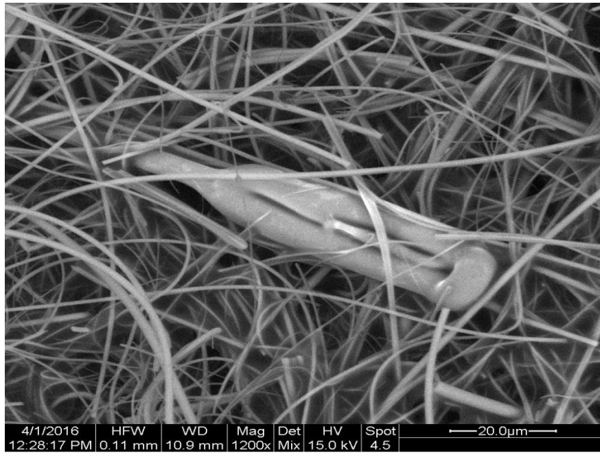
Εικόνα 9.15: Εικόνα SEM από το “pellet πύκο-οξιά-δρυς” στις εργαστηριακές συνθήκες καύσης με σόμπα pellet (μεγέθυνση 2400x).
