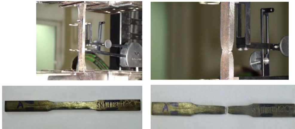
Σχήμα 3.50: Δοκίμιο SM1 δοκού IPE 120 πριν και μετά τη δοκιμή εφελκυσμού
