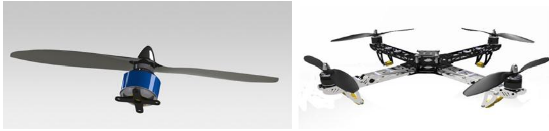
Εικόνα: Εφαρμογή κινητήρων τύπου BLDC σε drones
