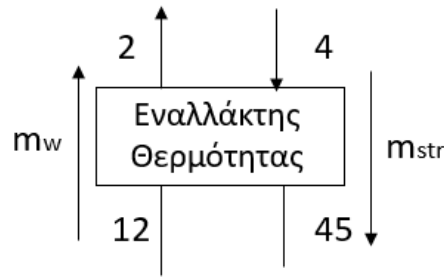
Εικόνα 3.4. Εναλλάκτης θερμότητας του διαλύματος Hex
