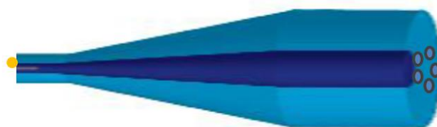
Εικόνα 4.3 : Το μικροσφαιρίδιο BaTiO_3 ημιεγκιβωτίζεται στο άκρο της ΜΟΙ
