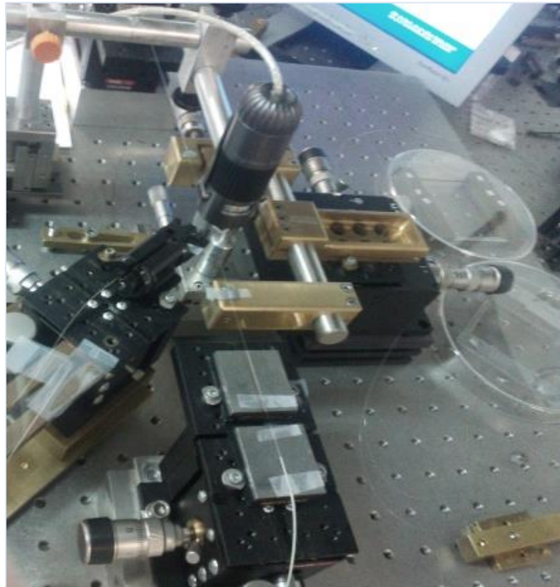
Εικόνα 4.8 : Η διάταξη του μεταγωγέα σχήματος T στην περίπτωση α(ii) δηλαδή υπό γωνία 63 μοιρών .
