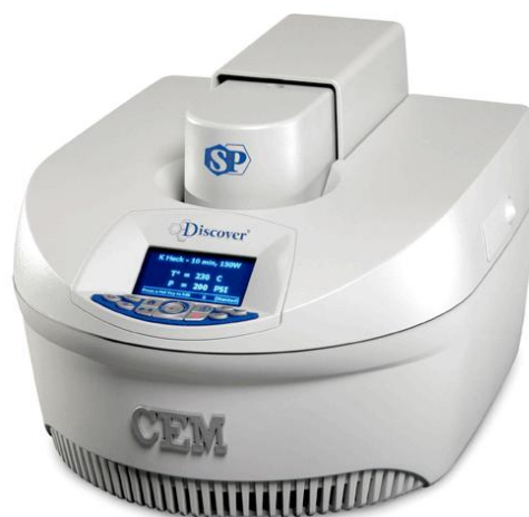
Εικόνα 1.2: Ένας σύγχρονος φούρνος μικροκυμάτων που χρησιμοποιείται στην οργανική σύνθεση
