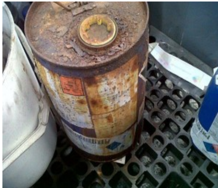
Εικόνα 1.18: Παράδειγμα κακής συσκευασίας όπου εξαιρετικά διαβρωτικά απόβλητα τοποθετήθηκαν σε βαρέλι από χάλυβα
