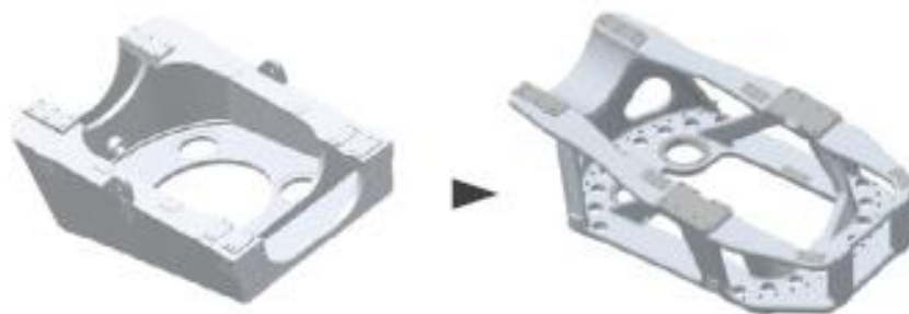
Εικόνα 2.4: Κύριο πλαίσιο τουρμπίνας ανέμου
