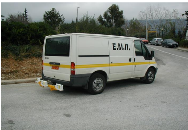
Σχήμα 4.5 Σύστημα όχημα - Laser Profiler του ΕΜΠ Πηγή : Λοΐζος και Πλατή, 2015
