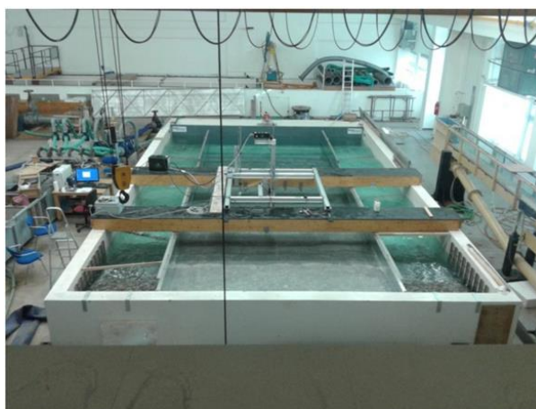
Σχ. 25. Γενική όψη της πειραματικής διάταξης πριν την κατασκευή του κυματοθραύστη και την τοποθέτηση της άμμου.
