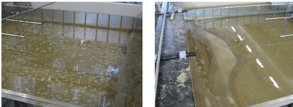
Σχ. 29. Όψη της αρχικής (στα αριστερά) και τελικής (μετά από 5 ώρες κυματικής δράσης, στα δεξιά) ακτογραμμής στο σενάριο Νο. 3.
