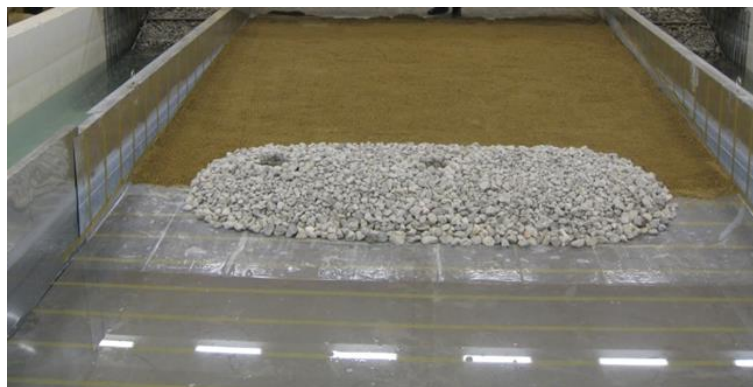
Σχ. 27. Όψη του κυματοθραύστη και της αμμώδους ακτής κατά τη φάση κατασκευής.
