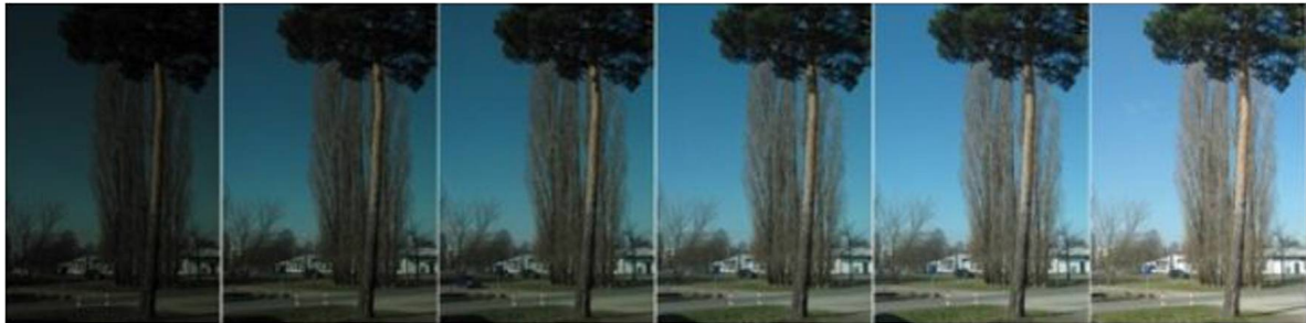
Σχήμα 1.2: Διαδοχική εναλλαγή χρώματος ενός θερμοχρωμικού πολυστρωματικού παραθύρου [22].
