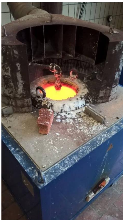
Εικόνα 4-6: Για την ανόπτηση χρησιμοποιήθηκε το πρώτο λουτρό (αριστερά) για θερμοκρασίες ~750-850 °C. Το δεύτερο λουτρό τηγμένου άλατος θερμάνθηκε σε χαμηλές θερμοκρασίες ~ 200 °C και χρησιμοποιήθηκε για τη γήρανση.
