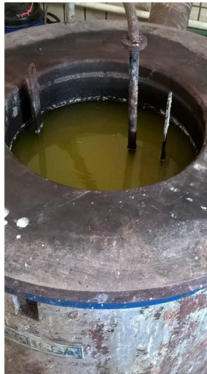
Εικόνα 4-6: Για την ανόπτηση χρησιμοποιήθηκε το πρώτο λουτρό (αριστερά) για θερμοκρασίες ~750-850 °C. Το δεύτερο λουτρό τηγμένου άλατος θερμάνθηκε σε χαμηλές θερμοκρασίες ~ 200 °C και χρησιμοποιήθηκε για τη γήρανση.
