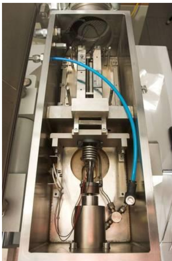
Εικόνα 4-2: Διάταξη του διαστολόμετρου DIL-805/D.
