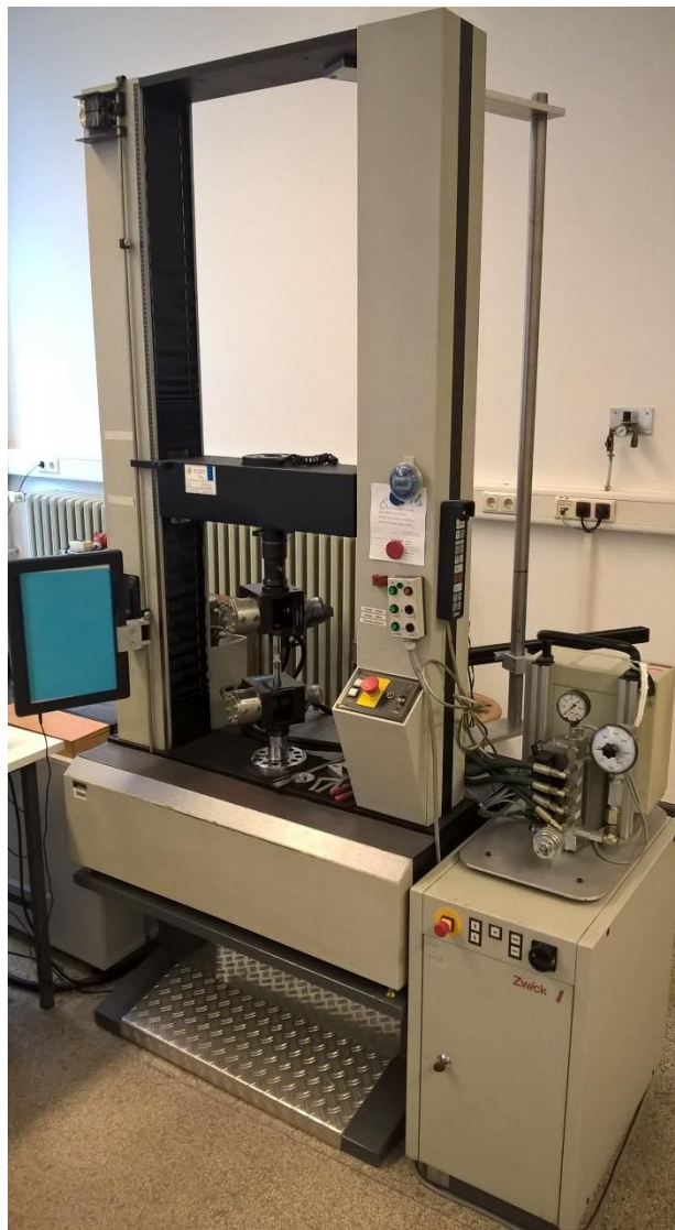
Εικόνα 4-7: Η διάταξη εφελκυστικής αντοχής Zwick-Z100.
