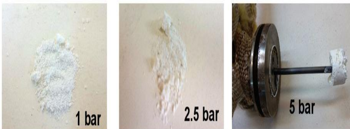
Εικόνα 6.6: Μορφολογικές διαφορές στο PA 6.Τ μετά από πολυμερισμό σε πιέσεις των 1bar, 2.5bar και 5bar
