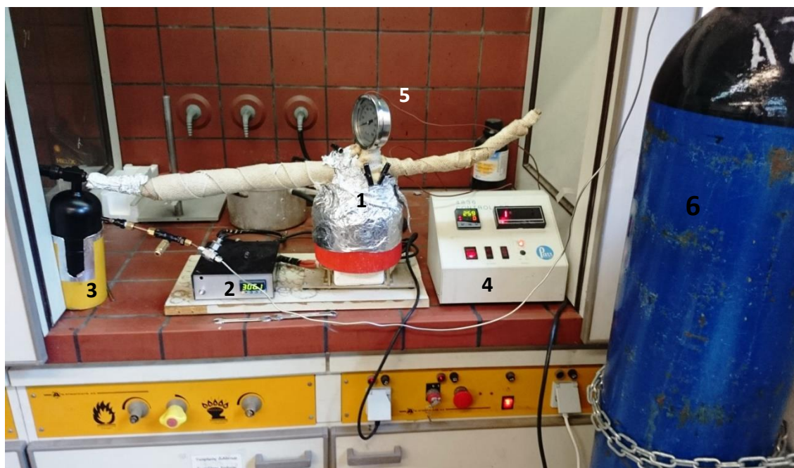
Εικόνα 6.2 Η πλήρης διάταξη του αντιδραστήρα που χρησιμοποιήθηκε για τον πολυμερισμό
