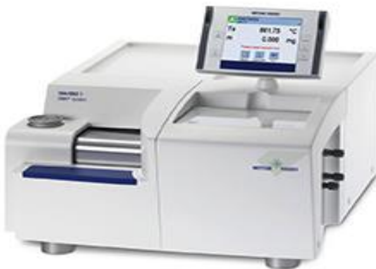
Εικόνα 4.7 Συσκευή DSC 1 της Mettler Toledo.
