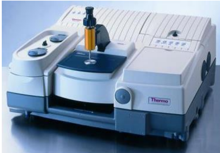
Εικόνα 3.3: Φασματοφωτόμετρο υπέρυθρου μετασχηματισμού Fourier, Nicolet 6700 thermoscientific του οίκου Thermo Electron Corporation [2]
