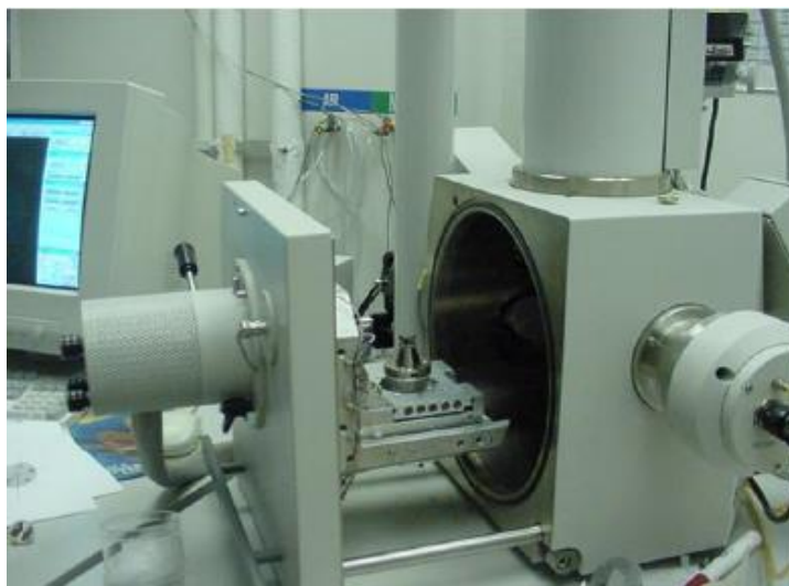
Εικόνα 3.5: Τροφοδοσία δείγματος στο θάλαμο του SEM Quanta 200 [2]
