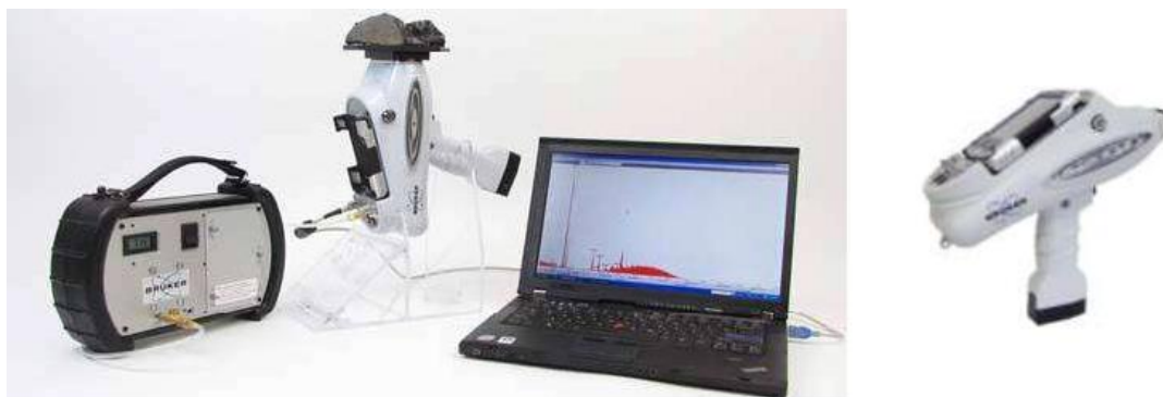
Εικόνα 3.1: Η φορητή συσκευή XRF τύπου Tracer III-V της εταιρίας Bruker-AXS. [87]
