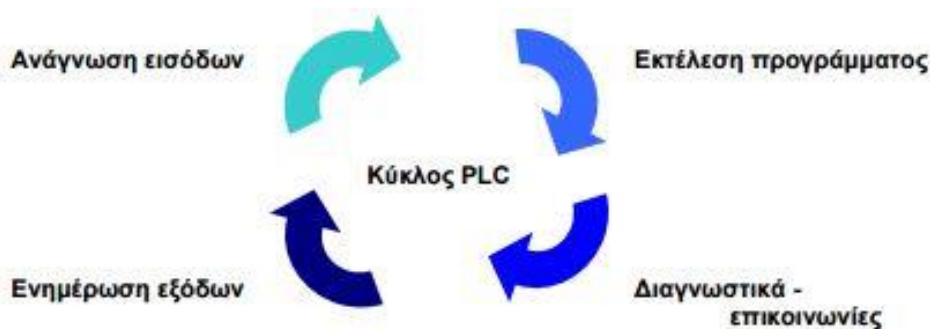
Σχήμα 22: Κύκλος λειτουργίας του PLC
