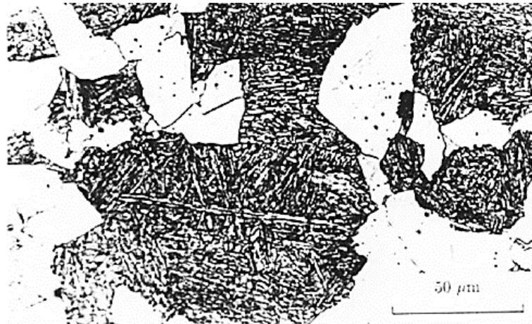
Εικόνα 1.4: Οπτική μικρογραφία συγκολλημένου μετάλλου, με μαρτενσίτη μετά από βαφή και αλλοτριόμορφο φερρίτη (λευκή περιοχή) κατά μήκος των ορίων των κόκκων του ωστενίτη [42]
