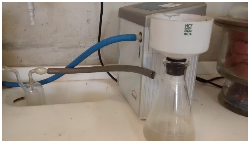
Εικόνα 27 Διαχωρισμός Σ/Υ με κενό αέρος
