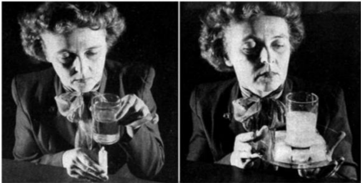
Εικόνα 5.2: Πείραμα της Δρ. Maria Telkes για την παρουσίαση της μετάβασης ενός υλικού αλλαγής φάσης, χρησιμοποιώντας ένα κερί και παγάκια (December 31, 1948)
