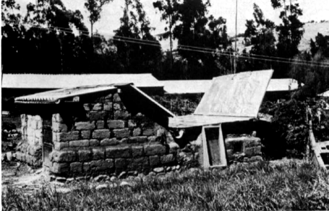
Εικόνα 4.2: Πειραματική εγκατάσταση του ερευνητή Benard. Αριστερά φαίνεται η αυλή και δεξιά η θερμαινόμενη από τον ήλιο περίφραξη
