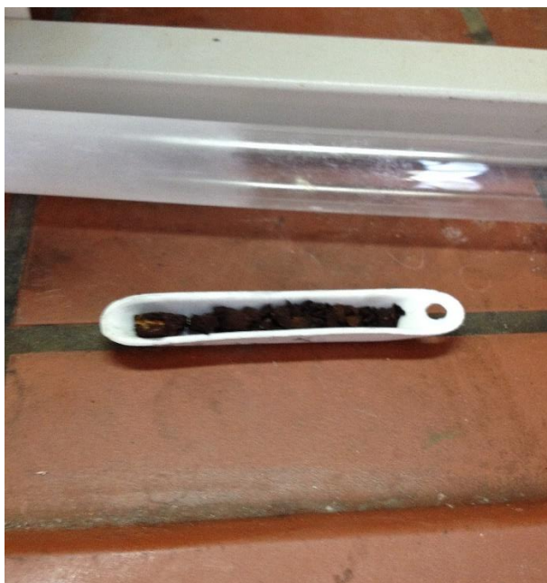
Εικόνα 32 Κεραμικό σκαφίδιο και σωλήνας χαλαζία
