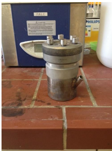
Εικόνα 31 Αυτόκλειστο που περιέχει 2,0g οξυνισμένου αταπουλγίτη μαζί με την κατάλληλη ποσότητα αλκοόλης ως πηγή άνθρακα
