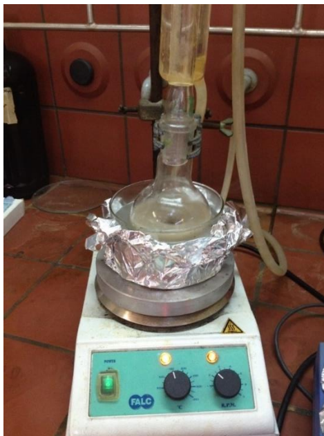
Εικόνα 30 Θερμική κατεργασία (reflux) του αταπουλγίτη με διάλυμα υδροχλωρικού οξέος, υπό ανάδευση
