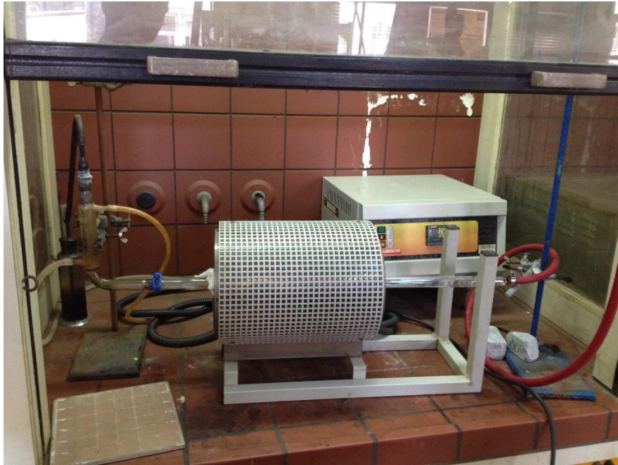
Εικόνα 33 Ο φούρνος που χρησιμοποιήθηκε για την πυρόλυση του μίγματος ατταπουλγίτη-αλκοόλη. Αριστερά φαίνεται το σύστημα ψύξης ενώ δεξιά ο κόκκινος σωλήνας είναι ο παροχή αργού(Ar 2 ). Πίσω από το φούρνο διακρίνεται ο αυτόματος ρυθμιστής της θερμοκρασίας
