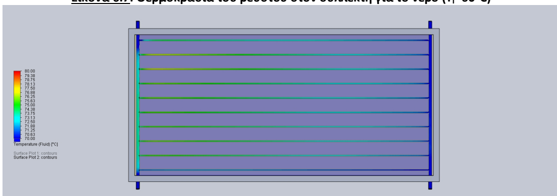
Εικόνα 6.8: Θερμοκρασία του ρευστού στον συλλέκτη για το νερό ( T_i=70^{\circ}\text{C} )
