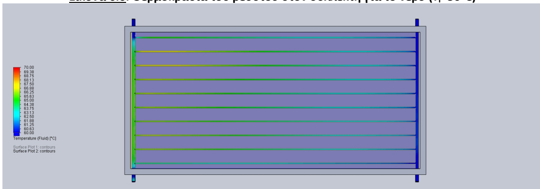
Εικόνα 6.7: Θερμοκρασία του ρευστού στον συλλέκτη για το νερό ( T_i=60^{\circ}\text{C} )
