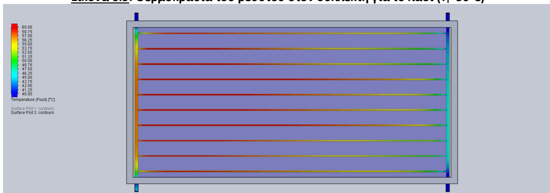
Εικόνα 6.10: Θερμοκρασία του ρευστού στον συλλέκτη για το λάδι ( T_i=40^\circ\text{C} )
