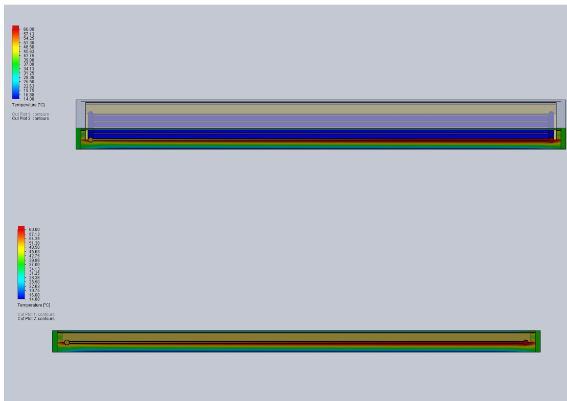
Εικόνα 6.34: Θερμοκρασία του ηλιακού συλλέκτη σε τομή κατά το μήκος του για το νανορευστό
