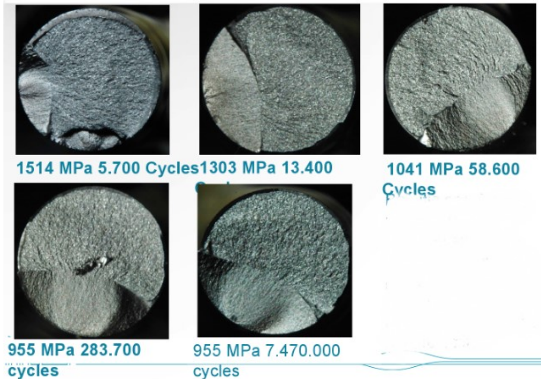
Εικόνα 30 : Επιφάνειες θραύσης των δειγμάτων μπαινίτη για διάφορες τάσεις.
