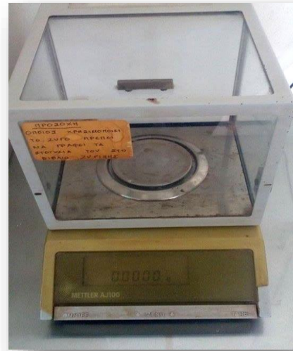
Εικόνα 2.20- Ζυγός ακριβείας για τη μελέτη της πυκνότητας
