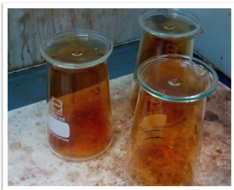
Εικόνα 2.14 - Παραγωγή νιτρώδων ατμών (χώνευση με βασιλικό νερό)
