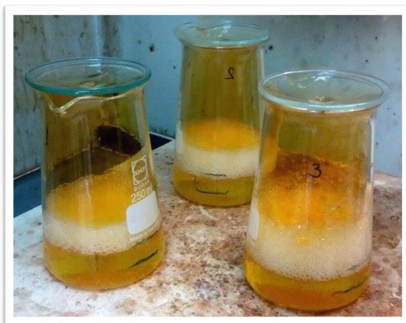
Εικόνα 2.15 – Προσθήκη βασιλικού νερού και ήπιος βρασμός δειγμάτων μέχρι το 1/3 του όγκου τους
