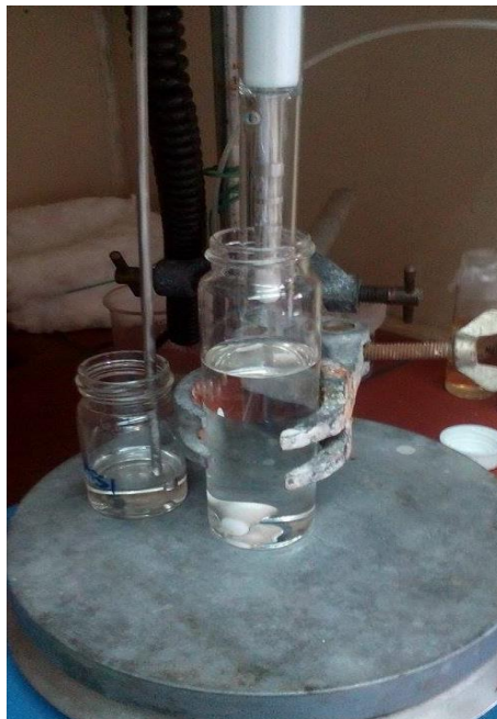
Εικόνα 2.24- Εμβάπτιση κυψελίδας αγωγιμότητας στο προς μελέτη διάλυμα
