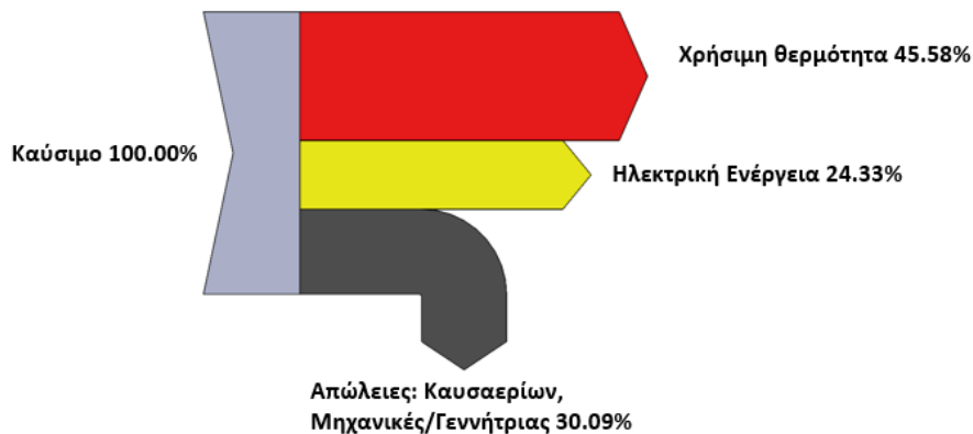
ΕΙΚΟΝΑ 4.2.1 ΔΙΑΓΡΑΜΜΑ SANKEY ΓΙΑ ΑΕΡΙΟΣΤΡΟΒΙΛΟ SOLAR SATURN 20
