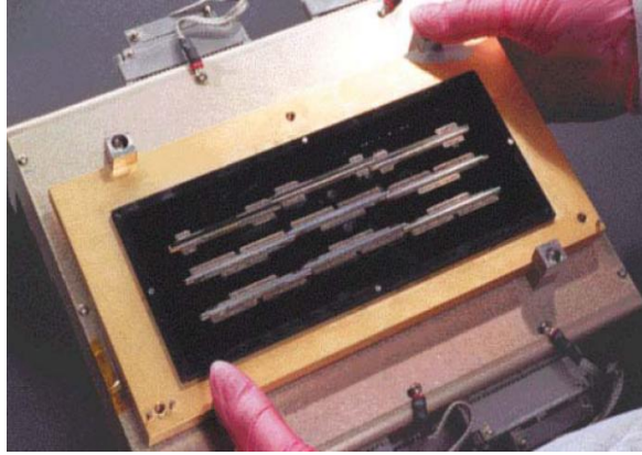
Σχήμα 2.6: Εστιακό επίπεδο με τους γραμμικούς αισθητήρες της κάμερας του IKONOS
