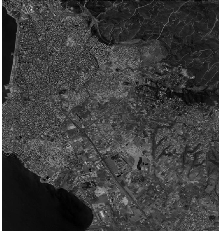
Σχήμα 5.11: Ορθοδιορθωμένη δορυφορική εικόνα EROS-B, εφαρμόζοντας το προτεινόμενο μοντέλο γεωαναφοράς με μέγεθος εικονοψηφίδας 0.73m.
