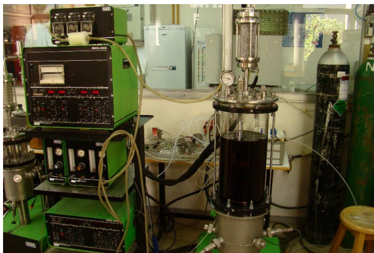
Εικόνα 4.7. Βιοαντιδραστήρας MBR AG Ltd. (Switzerland) συνδεδεμένος με συσκευή ελέγχου IMCS – 2000
