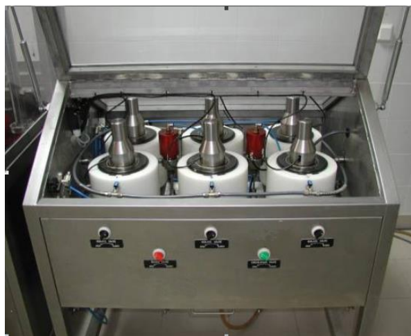
Εικόνα 4.3: Συστοιχία κυλινδρικών μικροθαλάμων ΥΠ χωρητικότητας 42 mL ο καθένας, που χρησιμοποιείται για κινητικές μελέτες
