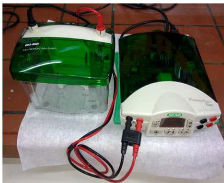
Εικόνα 4.10. Πειραματική διάταξη ηλεκτροφόρησης πήγματος ακρυλαμιδίου
