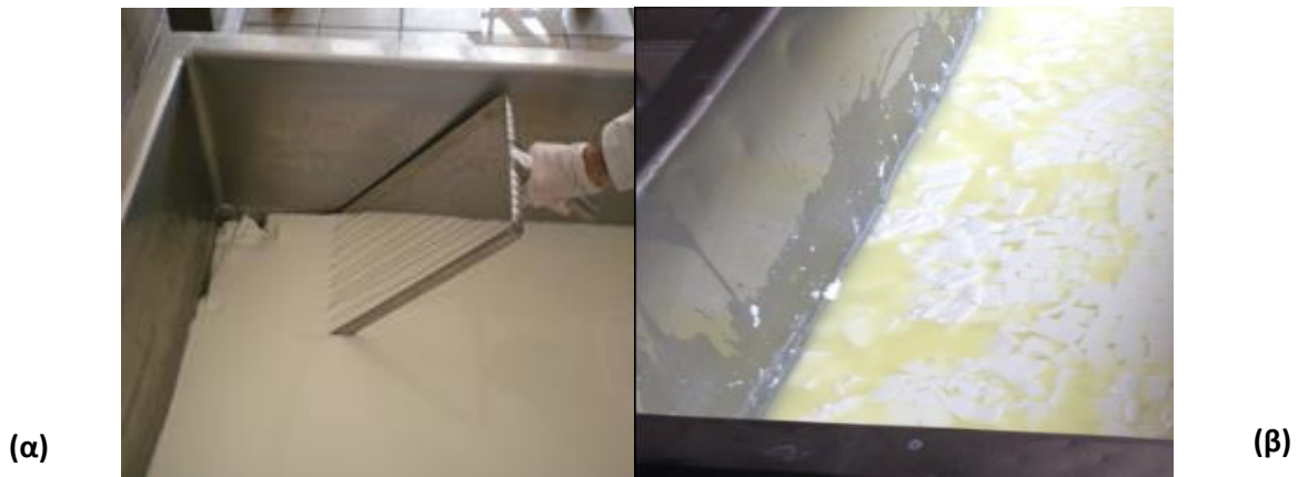
Εικόνα 4.14 α) Διαίρεση τυροπήγματος με ειδικούς τυροκόπτες και β) Αποβολή ορού από το τυρόπηγμα
