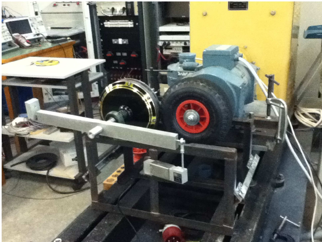
Σχήμα 3.2: Η οδήγηση της μηχανής ως γεννήτρια με την χρήση του βοηθητικού κινητήρα μέσω ρόδας και το ροπόμετρο εφαρμοσμένο στον άξονα της προς εξέταση μηχανής
