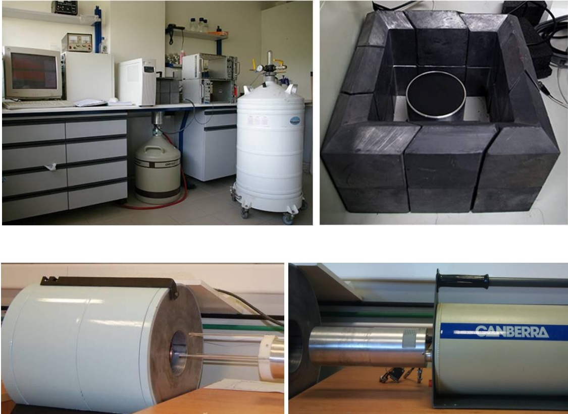
Σχήμα 2.1: Η ανιχνευτική διάταξη μέτρησης δειγμάτων ιζήματος στο ΕΛ.ΚΕ.Θ.Ε. (πάνω) και στο Ε.Μ.Π (κάτω).
