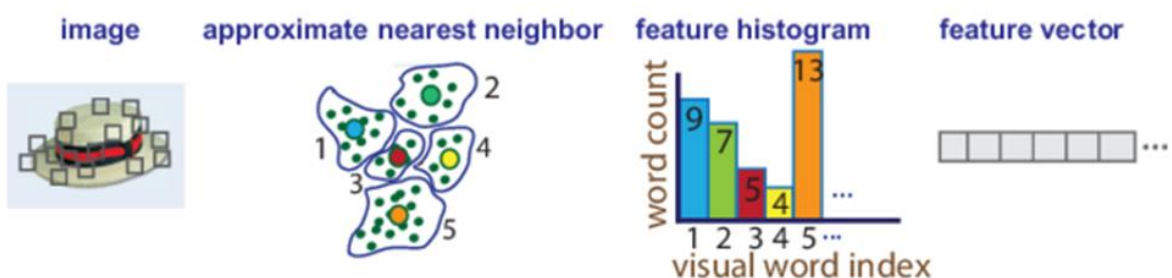
Εικόνα 4.3: Γραφική απεικόνιση της διαδικασίας εξαγωγής του διανύσματος των χαρακτηριστικών που χρησιμοποιείται ως είσοδος στον ταξινομητή με χρήση του Bag of Features.
