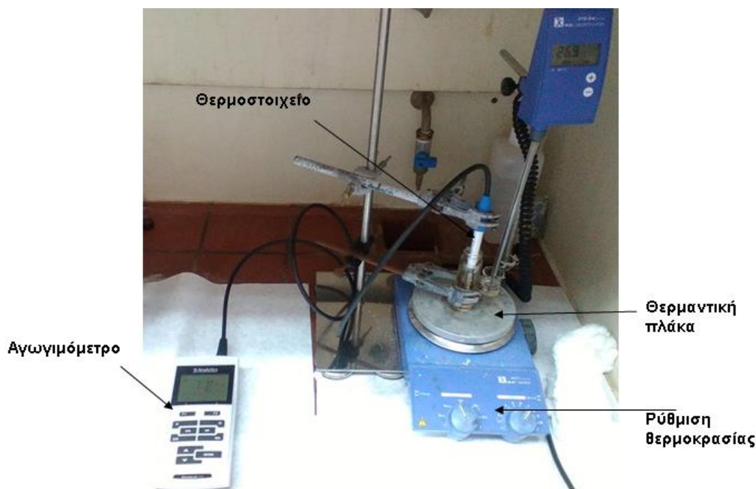
Εικόνα 2.9 Πειραματική διάταξη μετρήσεων αγωγιμότητας
