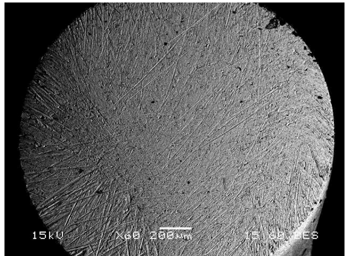
Εικόνα 3.7. Άποψη της καθοδικής επιφάνειας κατά την παρατήρηση στο SEM μετά το (α) 3 ο πείραμα και (β) 1 ο πείραμα
