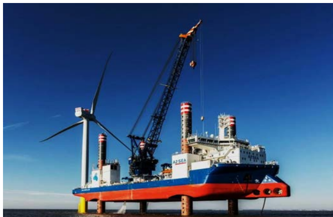
Σχήμα 12 Σκάφος Jack-up Πηγή: www.heavyliftspecialist.com
