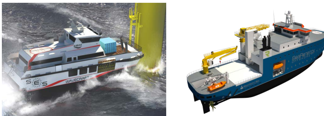
Σχήμα 24 (α) Μικρό σκάφος μεταφοράς εργαζομένων (β) Μεγάλο σκάφος πρόσβασης εργαζομένων (Offshore Access Vessel) Πηγή: (α) windpowermonthly (β) searenergy
