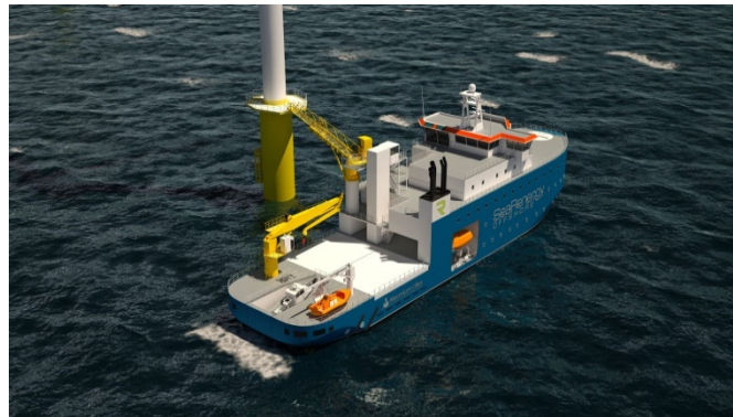
Σχήμα 25 Μηχανισμός πρόσβασης “Walk to work” Πηγή: seaenergy
