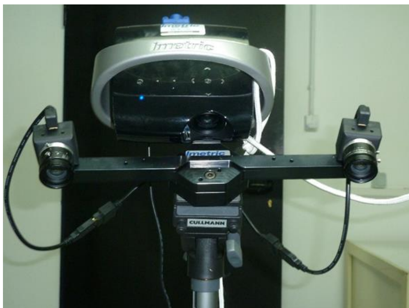
Σχήμα 5.1: Σαρωτής Iscan M300 του εργαστηρίου
