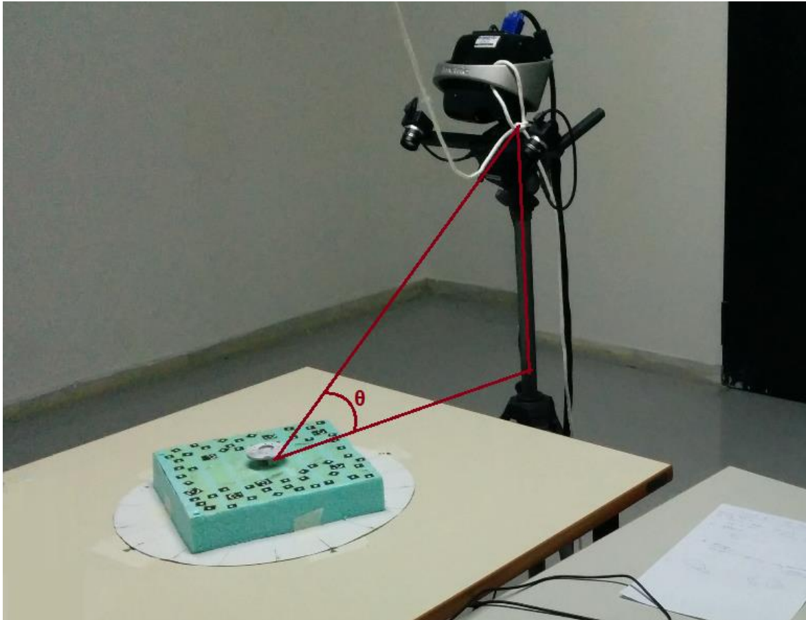
Σχήμα 5.3: Διάταξη σαρωτή-πλάκας στόχων όπου πραγματοποιήθηκε η σάρωση του τεμαχίου
