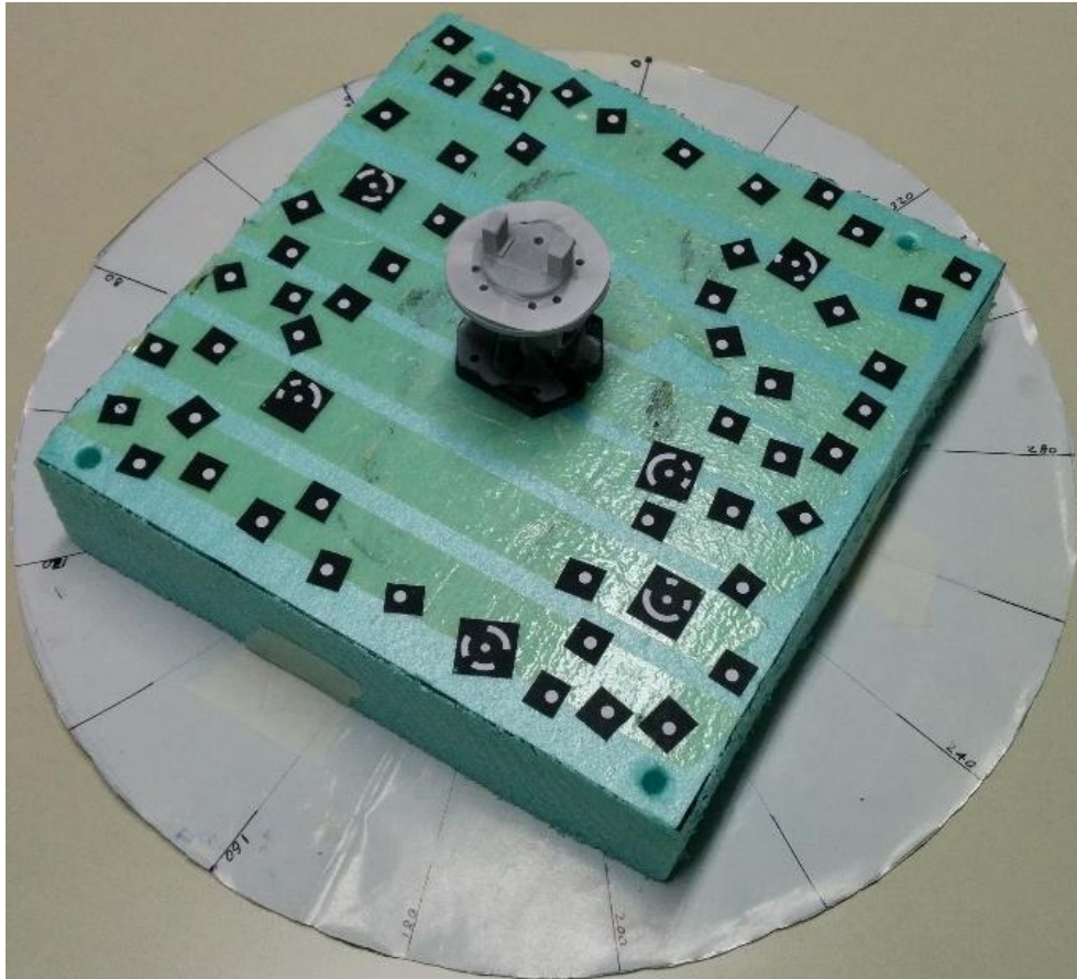
Σχήμα 5.2: Αυτοσχέδια πλάκα στόχων του εργαστηρίου μαζί με το ψεκασμένο αντικείμενο
