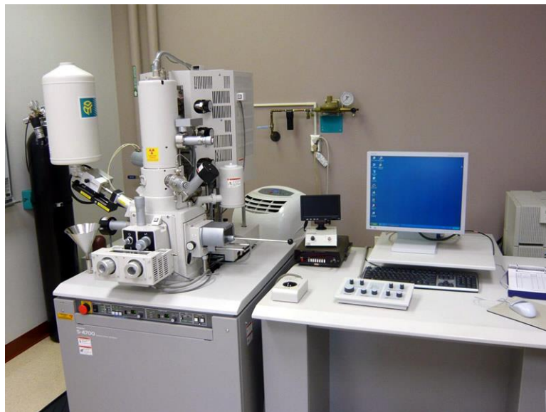
Εικόνα 5.3 : Μικροσκόπιο SEM (scanning electron microscope)
