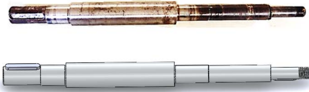
Σχήμα 3.8: Άτρακτος Επάνω: Πραγματικό μοντέλο | Κάτω: Μοντέλο CAD
