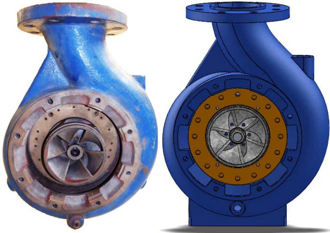
Σχήμα 3.17: Απεικόνιση της συναρμολογημένης διάταξης Αριστερά: Πραγματικό μοντέλο | Δεξιά: Μοντέλο CAD
