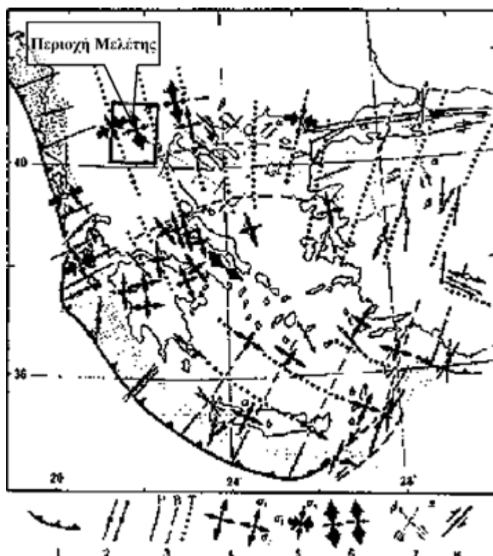
Σχήμα 3.5: Οι διευθύνσεις των κύριων αξόνων τάσης και το πεδίο των τεκτονικών τάσεων του Ελλαδικού χώρου. Σύνθεση από μηχανισμούς γένεσης επιφανειακών σεισμών, τεκτονική ανάλυση πρόσφατων και ενεργών ρηγμάτων και in situ μετρήσεις τάσεων. (1) όρια λιθοσφαιρικής βύθισης (subduction), ζώνη συμπίεσης εξωτερικά του Ελληνικού τόξου, (2) οριζόντιες προβολές των διανυσμάτων κίνησης, (3) οι κύριοι άξονες τάσεων, συμπίεση (P), ενδιάμεσος (B), εφελκυσμός (T) προσδιορισμένοι από μηχανισμούς γένεσης σεισμών, (4),(5) οι κύριοι άξονες τάσεων προσδιορισμένοι από νεοτεκτονική ανάλυση, (6) άξονες εφελκυσμού από in situ μετρήσεις τάσεων, (7) προβλεπόμενες δ/νσεις ρηγμάτων στο Β. Αιγαίο, (8) (Mercier, 1981) ρήγματα οριζόντιας μετατόπισης. (Παυλίδης, 1985)
