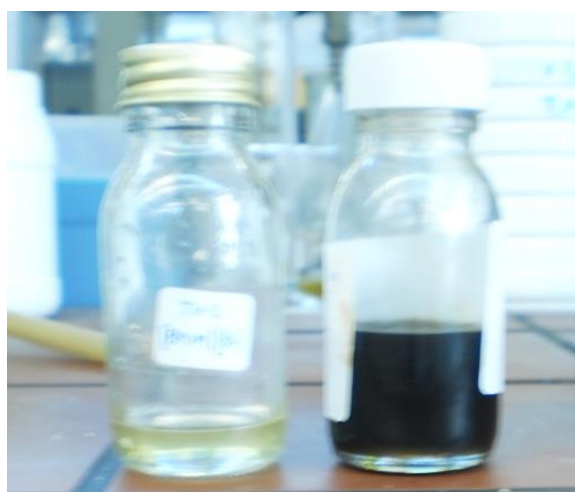
Εικόνα 8-1: Το ιοντικό υγρό [BMIM][Br] πριν από την εκχύλιση με τα δείγματα LCO (αριστερά) και μετά την εκχύλιση (δεξιά)
