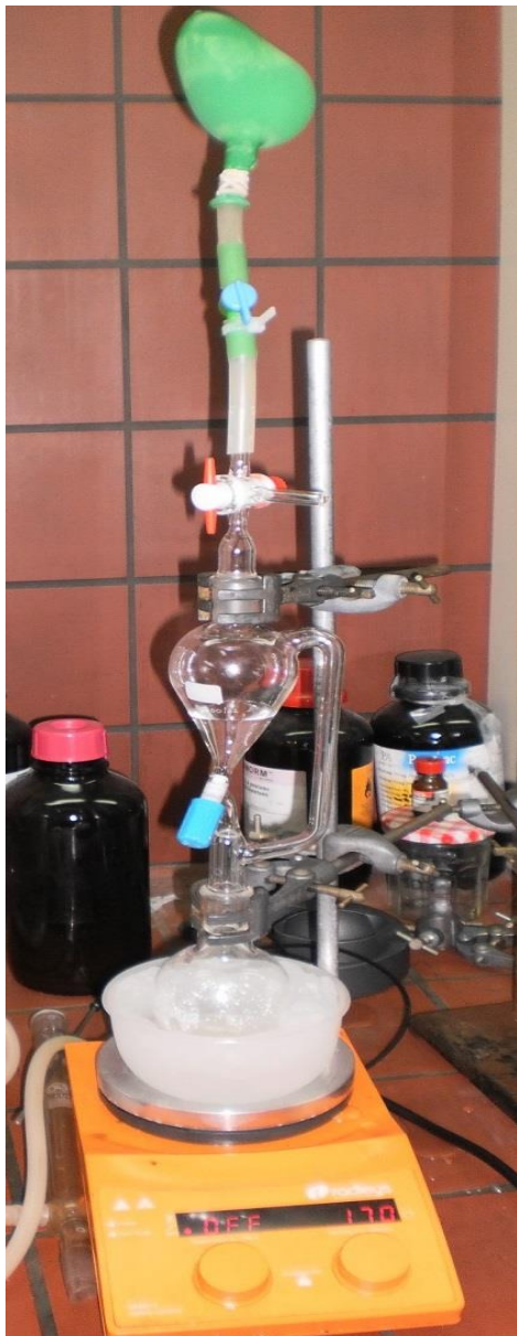
Εικόνα 7-1: Στάγδην προσθήκη 1-βρωμοβουτανίου σε 1-μεθυλιμιδαζόλιο.
