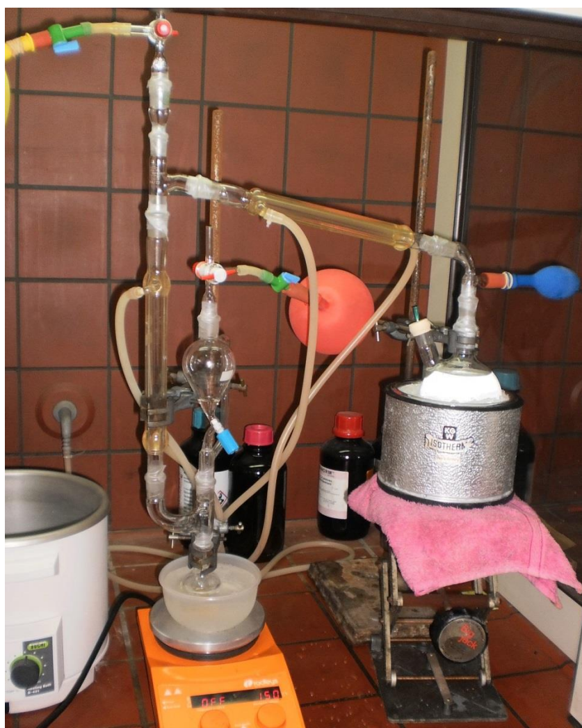
Εικόνα 7-4: Διάταξη σύνθεσης [BMIM][HSO 4 ] με προσθήκη θειικού οξέος
