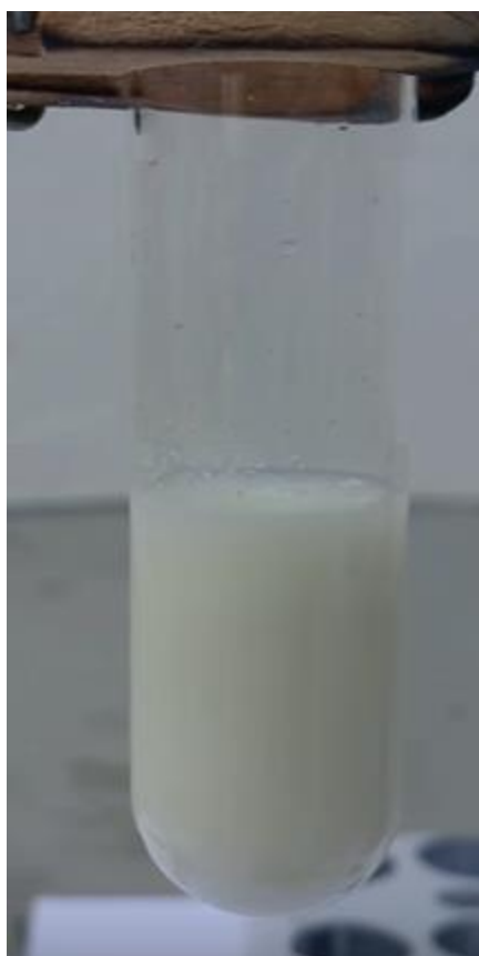
Εικόνα 7-7: Σχηματισμός λευκού ιζήματος εξαιτίας της παραγωγής AgBr
