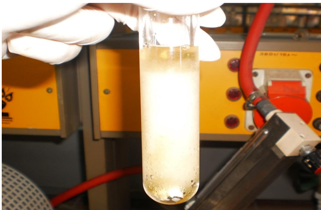
Εικόνα 7-5: Τα αντιδρώντα [BMIM][Br] και NaHSO 4 ·H 2 O έχουν εισαχθεί στον αντιδραστήρα
