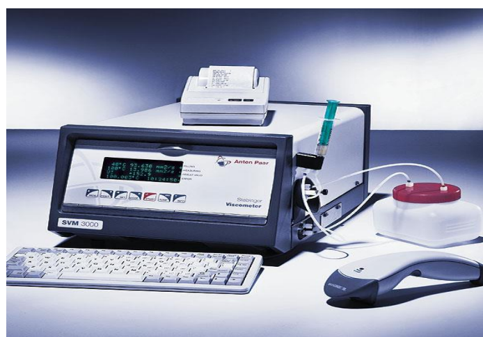
Εικόνα 6-1: Συσκευή SVM 3000 Stabinger Viscometer της Anton Paar. [1]
