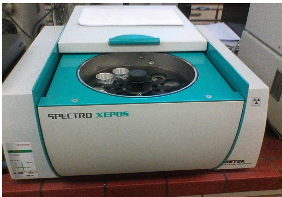
Εικόνα 6-3: Στοιχειακός αναλυτής με φθορισμό ακτίνων X SPECTRO XEPOS της AMETEK
