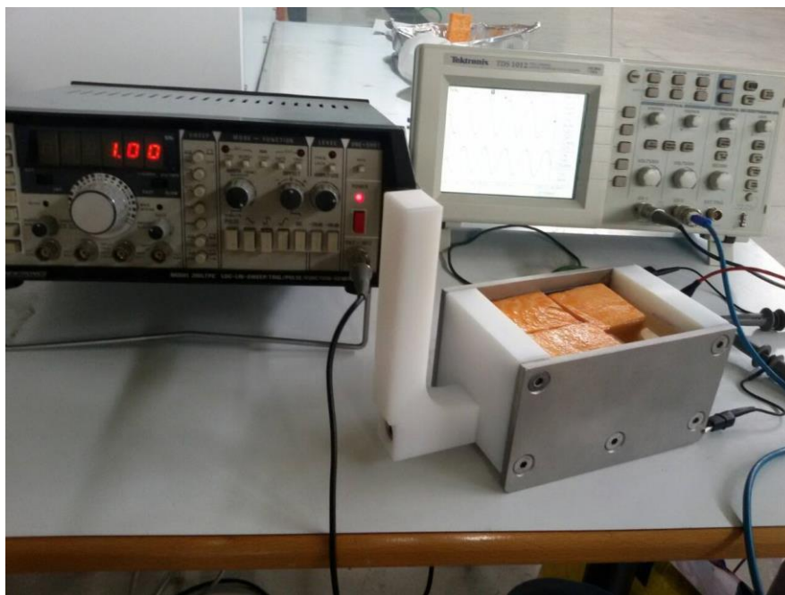
Εικόνα 3.1Η γεννήτρια συχνοτήτων Newtronics 200LTPC (αριστερά) και ο παλμογράφος TektronixTDS1012 (δεξιά)
