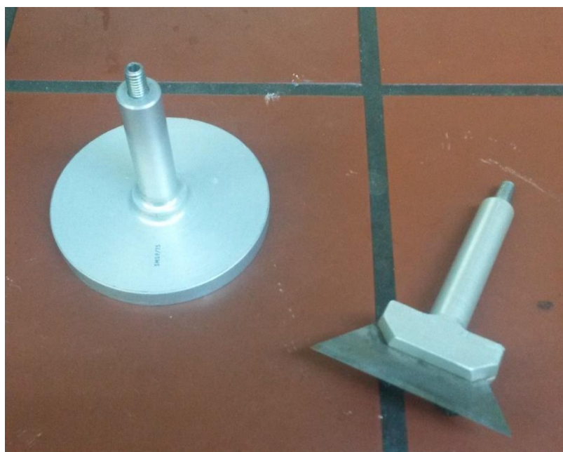
Εικόνα 3.7 Στελέχη που χρησιμοποιήθηκαν στον αναλυτή υφής για τα πειράματα. (αριστερά: κυκλικός δίσκος διαμέτρου 75 mm, δεξιά: λεπίδα)
