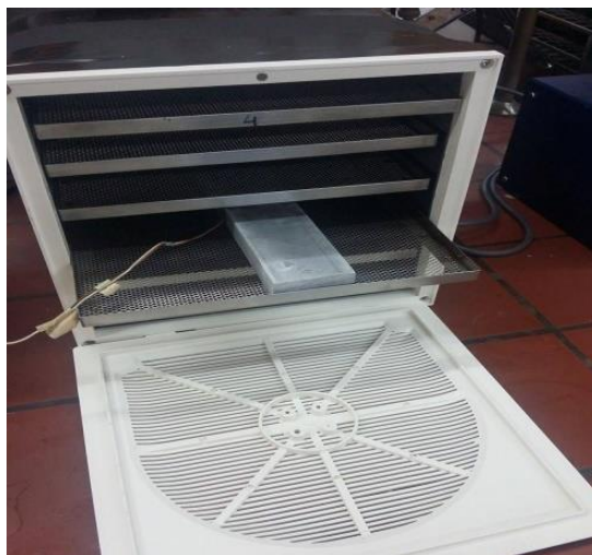
Εικόνα 3.5 Εισαγωγή πλάκας με θερμοστοιχείο στον ξηραντήρα
