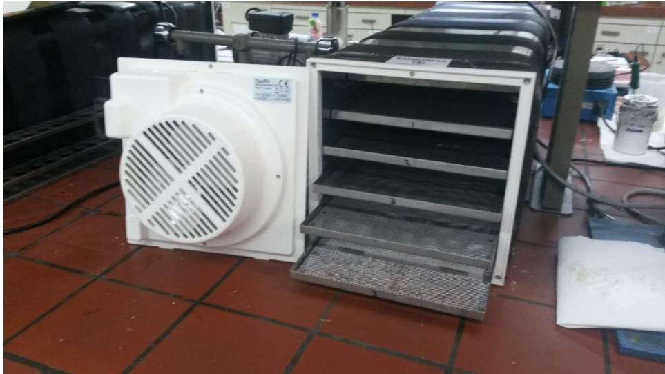
Εικόνα 3.4 Ξηραντήρας Biosec (συντελεστής συναγωγής h=11.3\text{W/m}^2\cdot\text{K} ).
