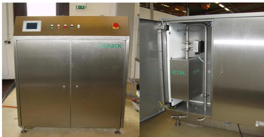
Εικόνα 3.2 Μονάδα παλλόμενων ηλεκτρικών πεδίων Elcrack-5kW, DIL
