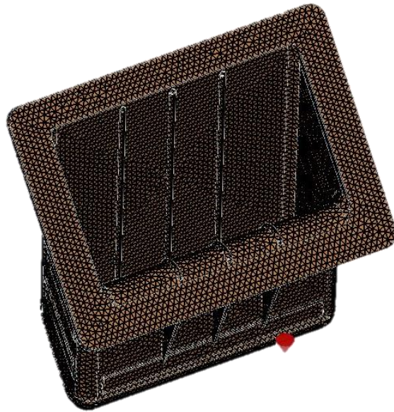
Εικόνα 3.3.2.1-1: Πλεγματοποίηση της μιας κοιλότητας.
