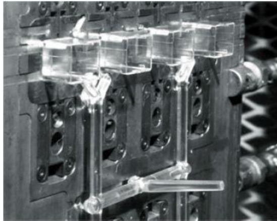
Εικόνα 2.6.1-1: Αποκόλληση παραγόμενου τεμαχίου από το κομμάτι διανομής κατά την εξώλκευση.
