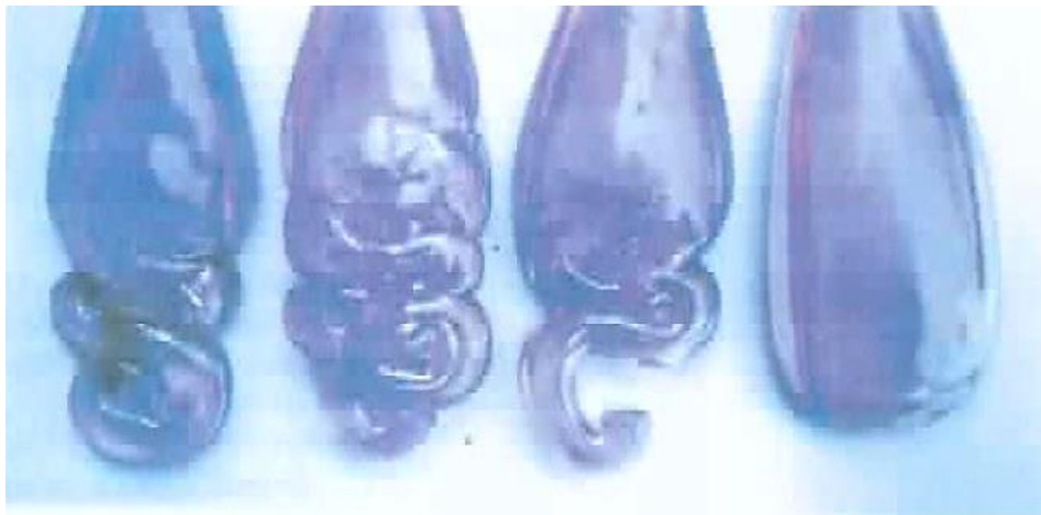
Εικόνα 2.9.2.3-2: Ημιτελή αντικείμενα χύτευσης λόγω jetting.
