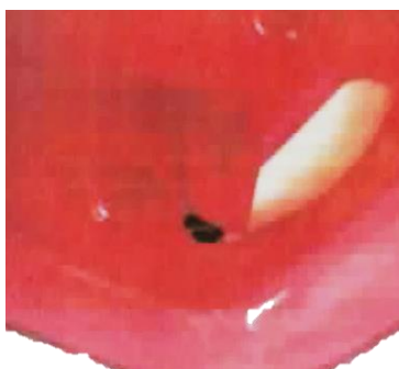
Εικόνα 3.2.5-1: Στίγμα καψίματος λόγω κακής εξαέρωσης.
