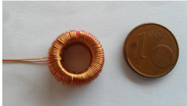
Σχήμα 4.8: Σύγκριση μεγέθους του μετασχηματιστή ρεύματος με ένα λεπτό του Ευρώ.
