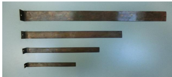
Σχήμα 2.12: Τα δοκίμια (χάλκινες ταινίες γείωσης) που τοποθετούνται στη δεξαμενή.
