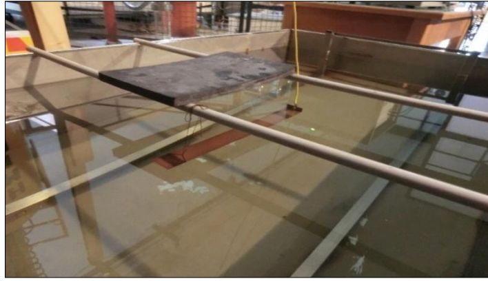
Σχήμα 2.13: Μηχανισμός στήριξης ηλεκτροδίου μέσα στη δεξαμενή.
