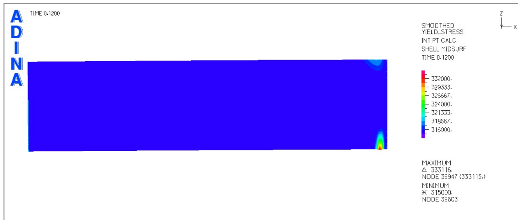
Εικόνα 4-15: Κατανομή τάσεων με κανονικοποίηση ως προς την τάση διαρροής κατά τον τοπικό λυγισμό (σημείο 2)
