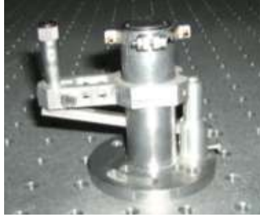
Figure 2.6.1.2: Το κελί κενού που χρησιμοποιήθηκε στα πειράματά μας
