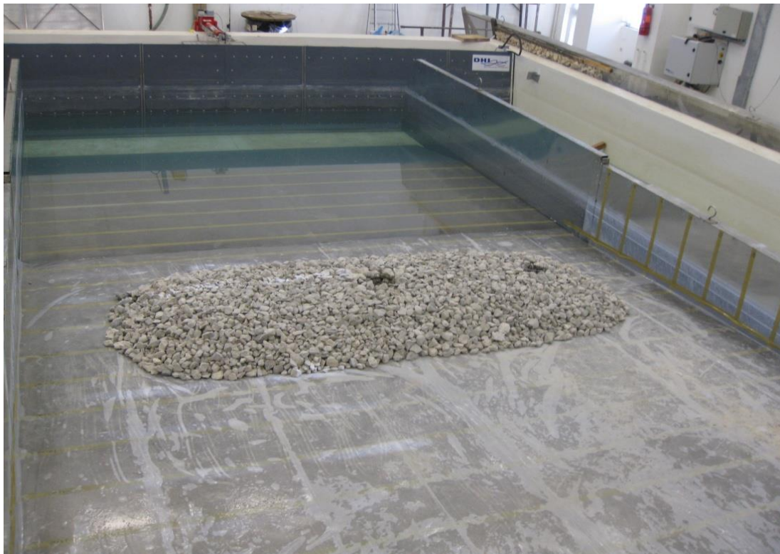
Εικόνα 5.17 Απεικόνιση του φυσικού ομοιώματος της δεξαμενής κυμάτων προς τα ανάντη.
