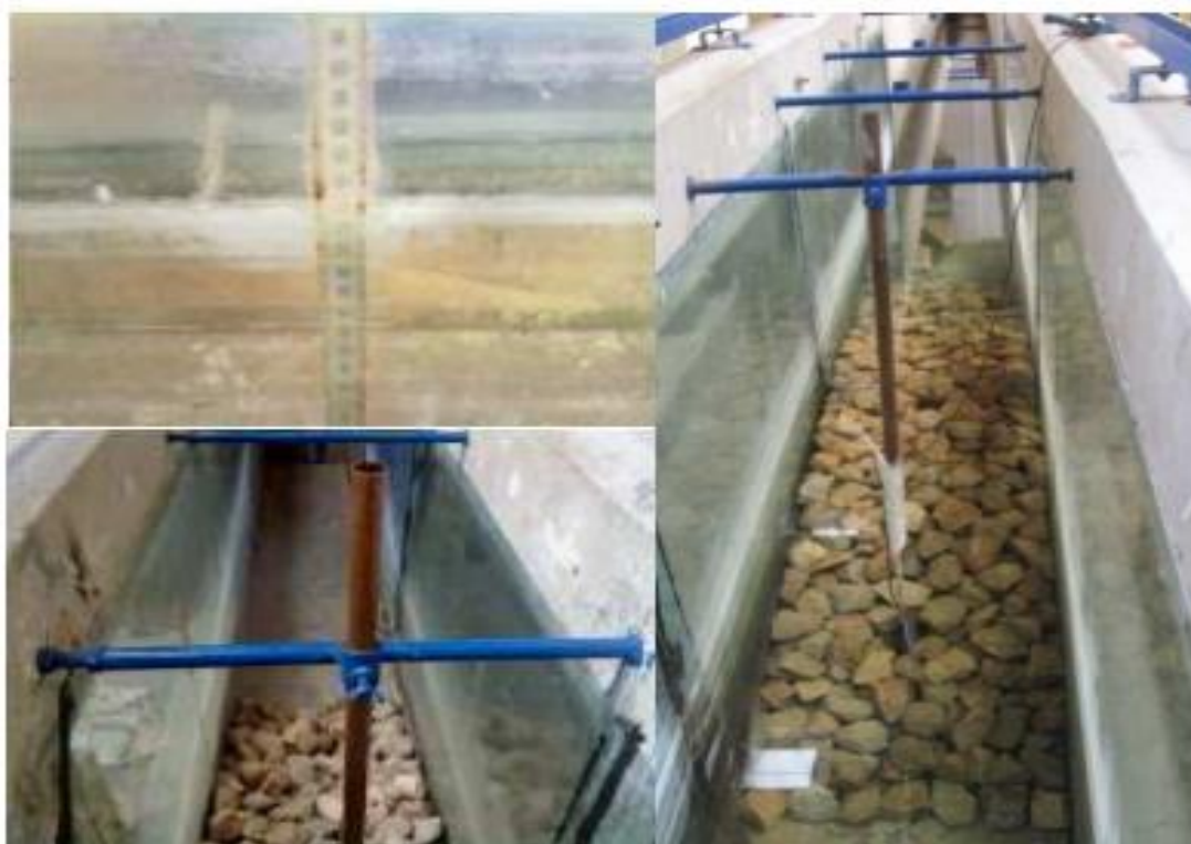
Εικόνα 5.10 Απεικόνιση του πειραματικού μοντέλου και των θέσεων μέτρησης των υδροδυναμικών πιέσεων.
