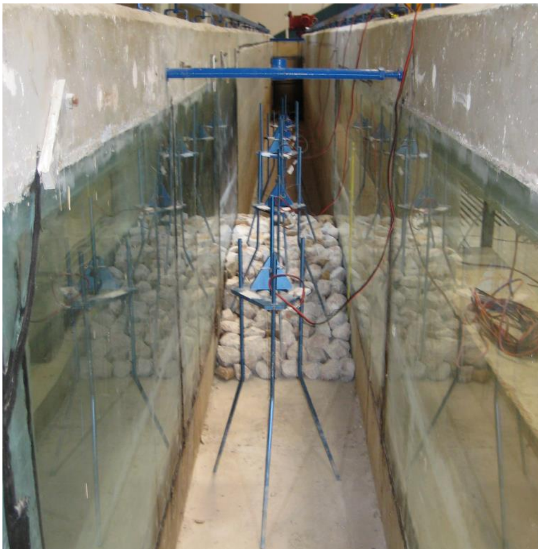
Εικόνα 5.12 Άποψη της πειραματικής διάταξης διαπερατού ύφαλου κυματοθραύστη από κατάντη αυτού.
