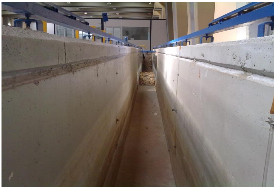
Εικόνα 5.2 Άποψη του εσωτερικού της διώρυγας βαρύτητας του εργαστηρίου λιμενικών έργων.
