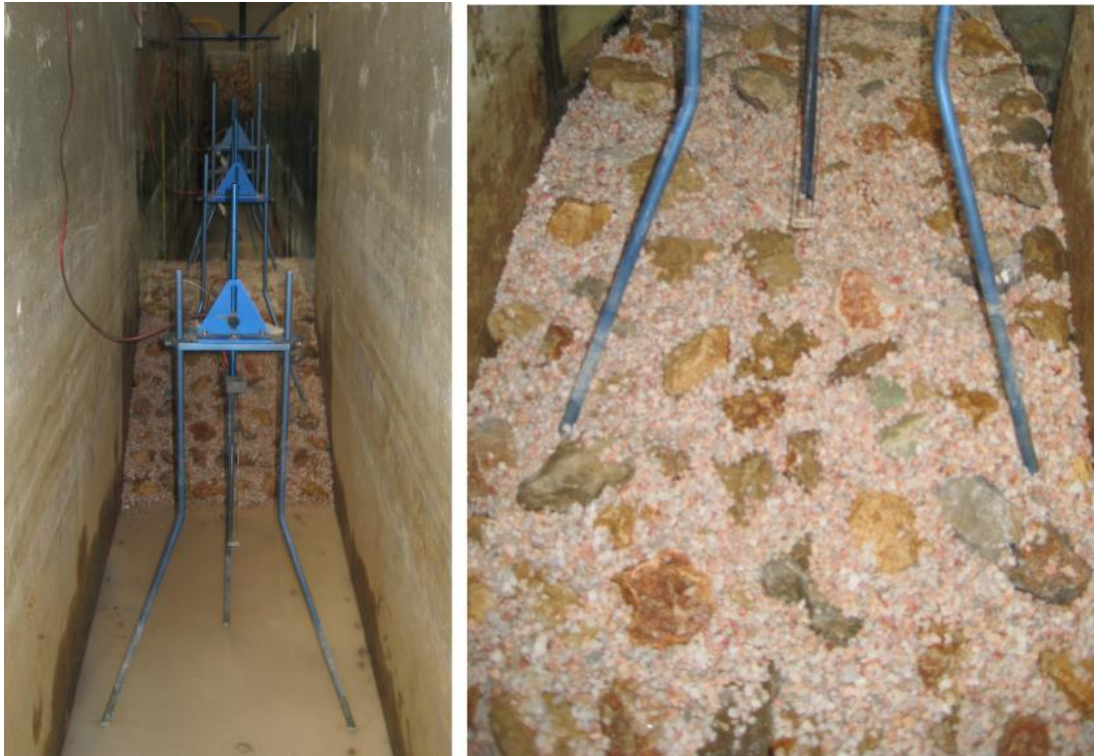
Εικόνα 5.13 Άποψη της πειραματικής διάταξης αδιαπέρατου ύφαλου κυματοθραύση.
