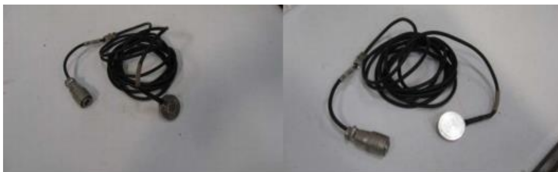
Εικόνα 5.8 Το πιεσόμετρο KYOWA BE-5KC που χρησιμοποιήθηκε για την μέτρηση των πιέσεων στο εσωτερικό του ύφαλου διαπερατού κυματοθραύστη.
