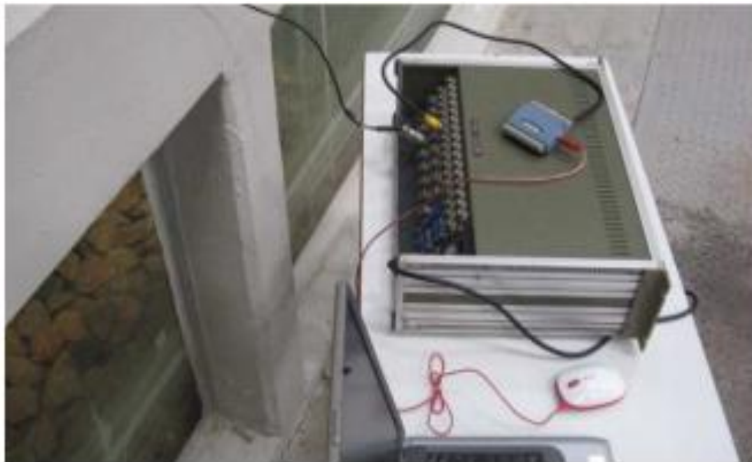
Εικόνα 5.9 Συνδεσμολογία οργάνων για τη λήψη των πειραματικών δεδομένων των ολικών πιέσεων στο εσωτερικό του κυματοθραύστη.
