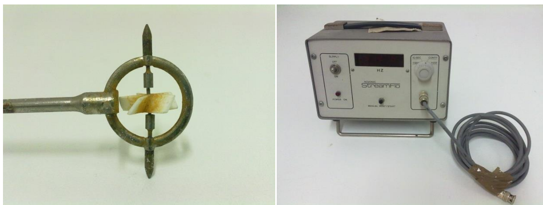
Εικόνα 5.6 Ο μιλίσκος που χρησιμοποιήθηκε για τη λήψη των πειραματικών μετρήσεων στο εσωτερικό της κατασκευής με το όργανο Nononic StreamFlo
