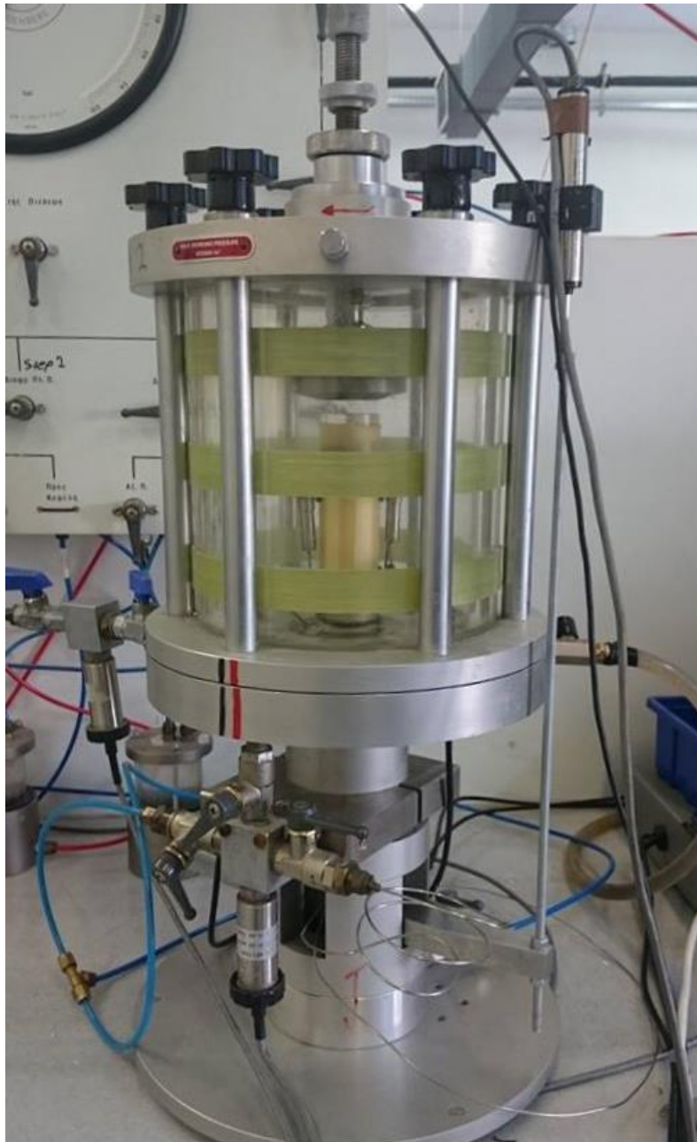
Εικόνα 4.4.1 Τριαξονική συσκευή εργαστηρίου εδαφομηχανικής ΕΜΠ
