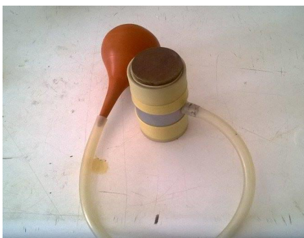
Εικόνα 5.3.1 Τοποθέτηση ελαστικής μεμβράνης και πορόλιθων στο δοκίμιο
