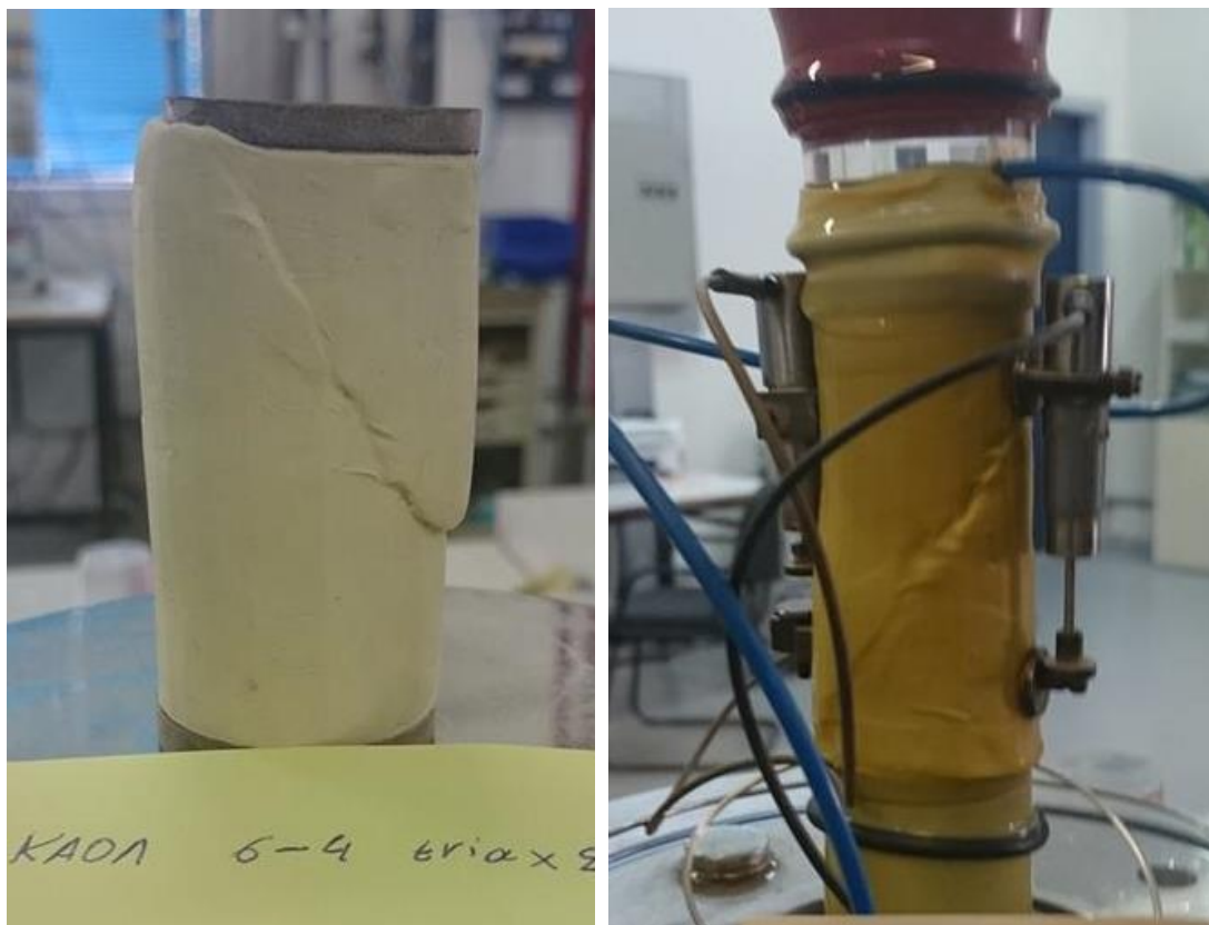
Εικόνα 5.4.1 Επίπεδο αστοχίας κατά την τριαξονική θλίψη σε δύο δοκίμια καολίνη
