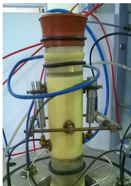
Εικόνα 5.3.2 Δοκίμιο καολίνη τοποθετημένο πάνω στη τριαξονική συσκευή
