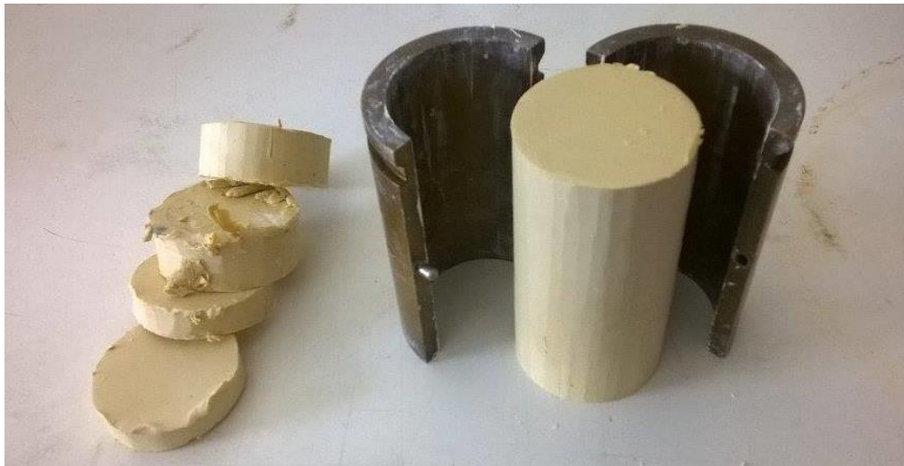
Εικόνα 5.2.3 (α),(β),(γ),(δ) Διαδικασία μόρφωσης δοκιμίων καολίνη για την τριαξονική συσκευή
