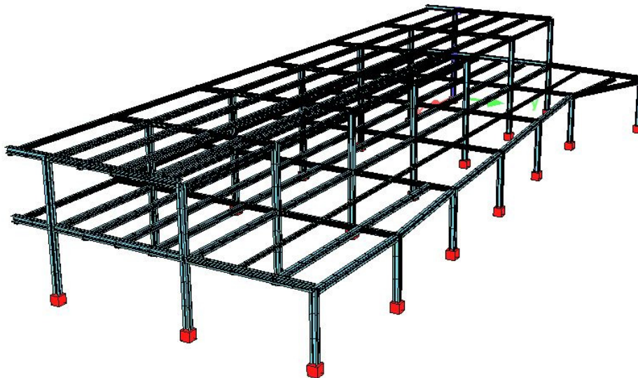
Σχήμα 4.2 Προσομοίωμα κτηρίου στη φάση κατασκευής
