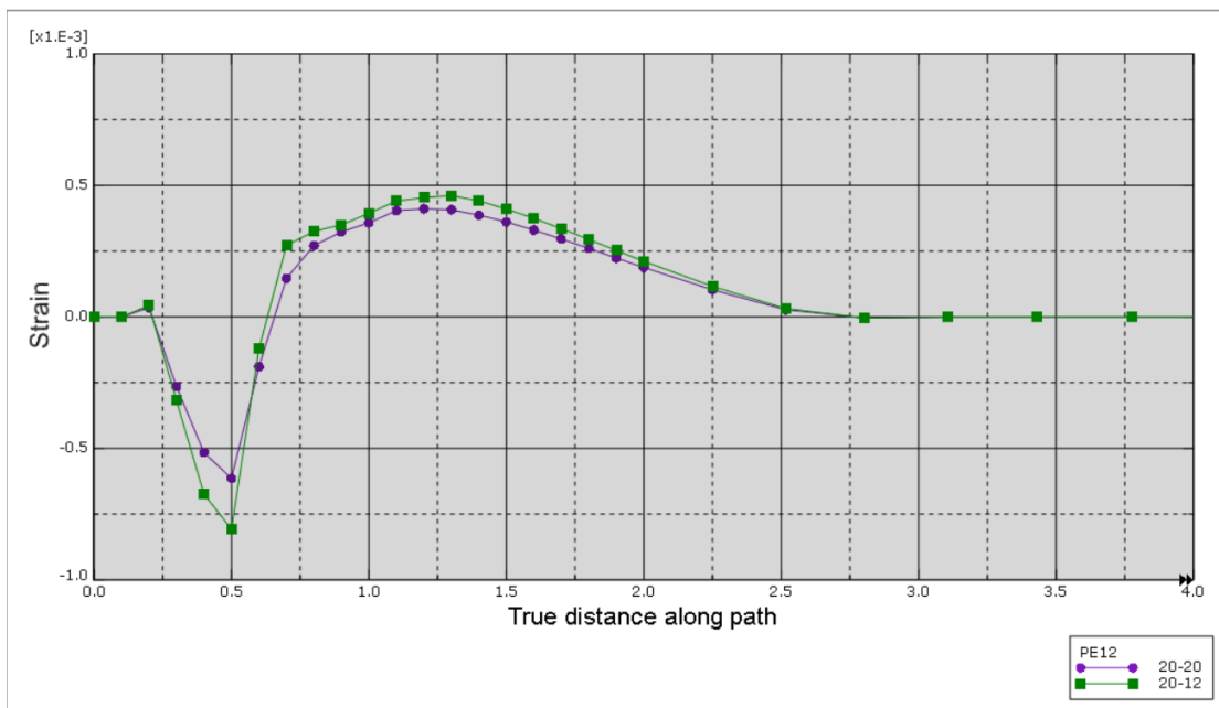
4.43 Σύγκριση των πλαστικών διατμητικών παραμορφώσεων \varepsilon_{xz}^p για associated και non-associated κανόνα πλαστικής ροής υπό μέγιστη τιμή φορτίου 375kPa .
